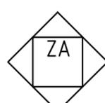
Светозвуковой сигнализатор превышения уровня загазованности, установленный по месту
