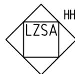
Сигнализатор верхнего аварийного уровня, установленный на резервуаре (емкости)
