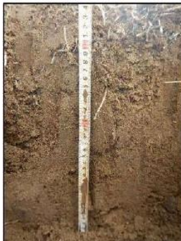
Рисунок 10.2 – Профиль отсыпанных грунтов
