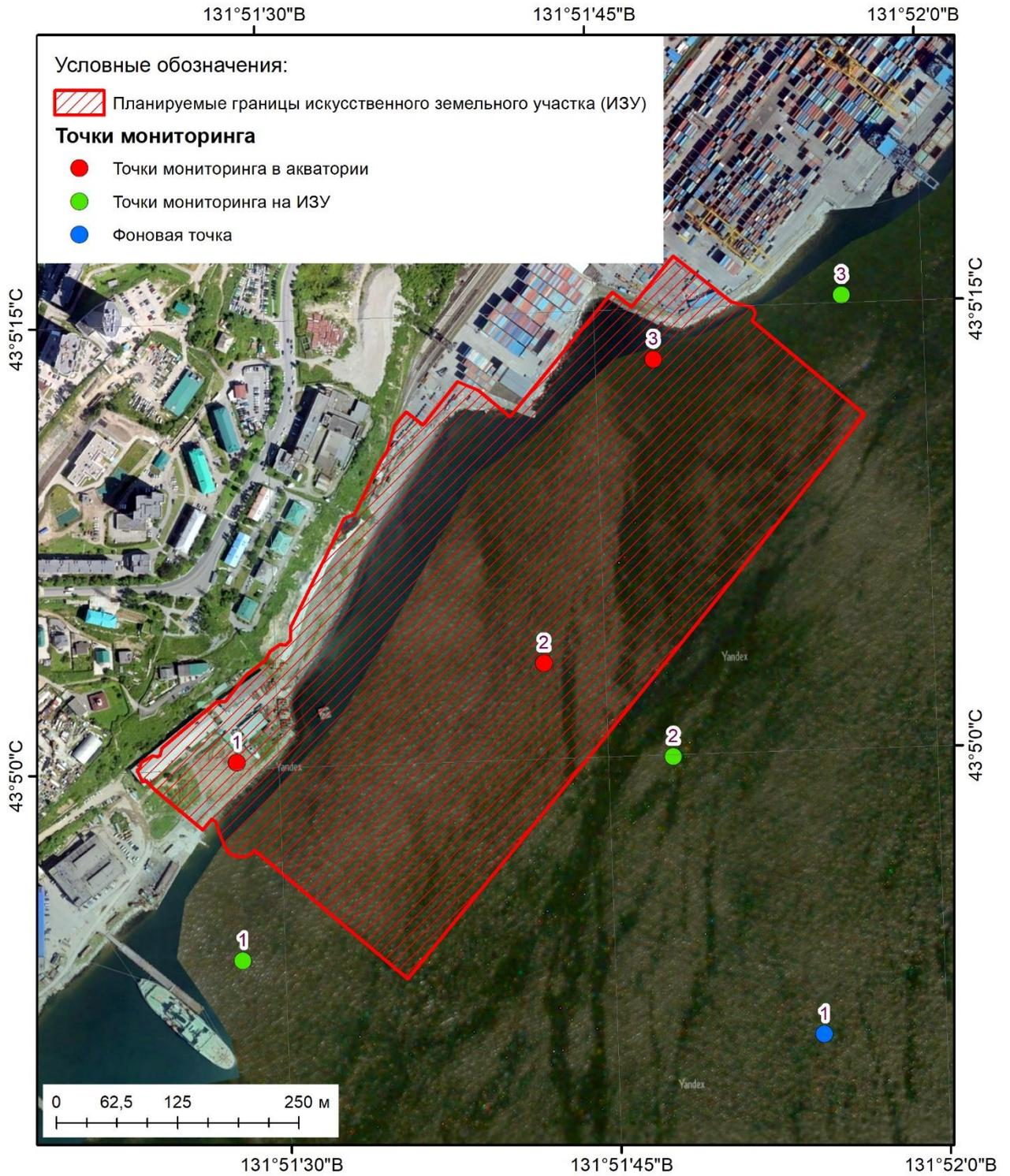
Рисунок 8.4-2. Схема размещения станций мониторинга в период эксплуатации
