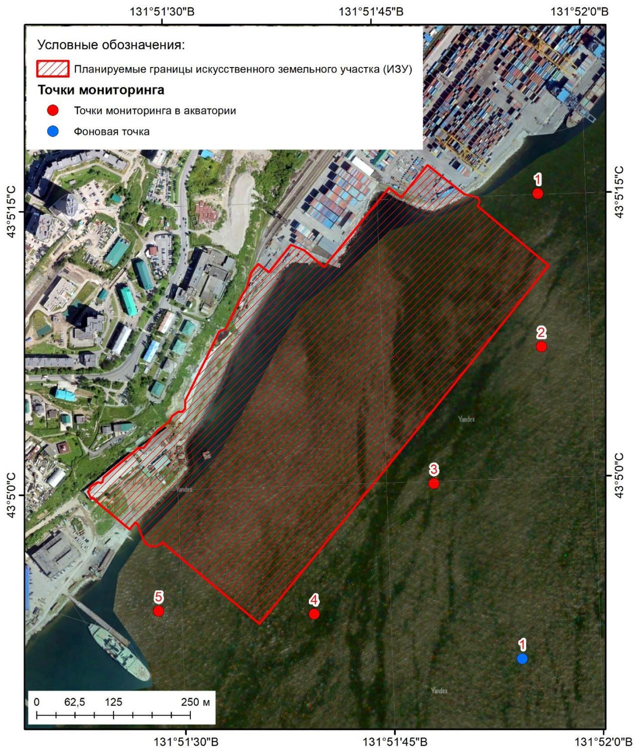
**Рисунок 8.4-1. Схема размещения станций мониторинга в период строительства**
