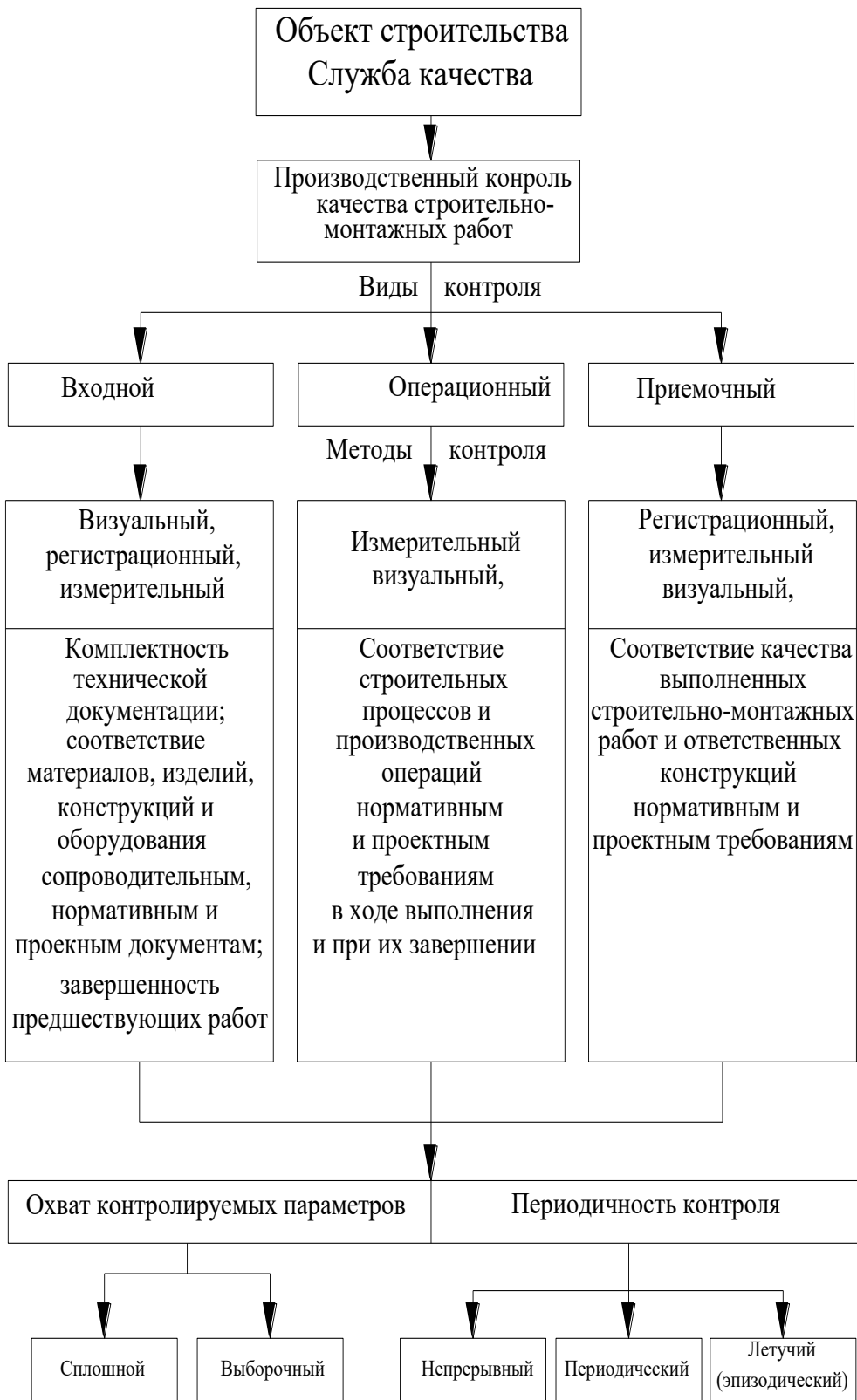
Рисунок 1 - Схема производственного контроля качества строительно-монтажных работ
