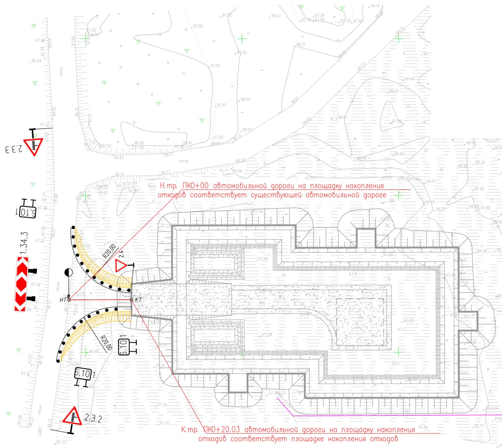
Н.тр. ПК0+00 автомобильной дороги на площадку накопления отходов соответствует существующей автомобильной дороге
