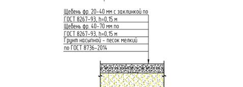
Конструкция водоотводной канавы
