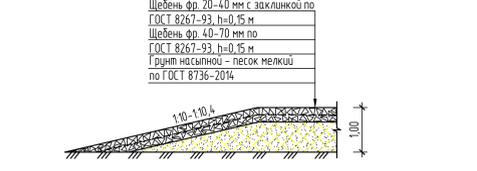
Конструкция щебеночного покрытия площадки для пожарной техники
