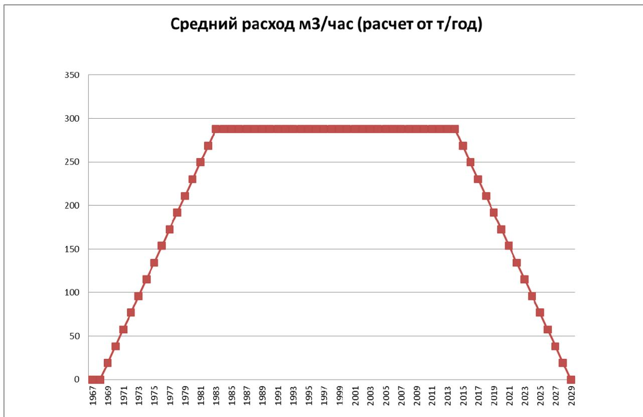
**Рисунок 2 График полного цикла сбраживания отходов от полигона ТКО в г. Новочеркасск относительно максимального расхода выделения биогаза м<sup>3</sup>/час**
