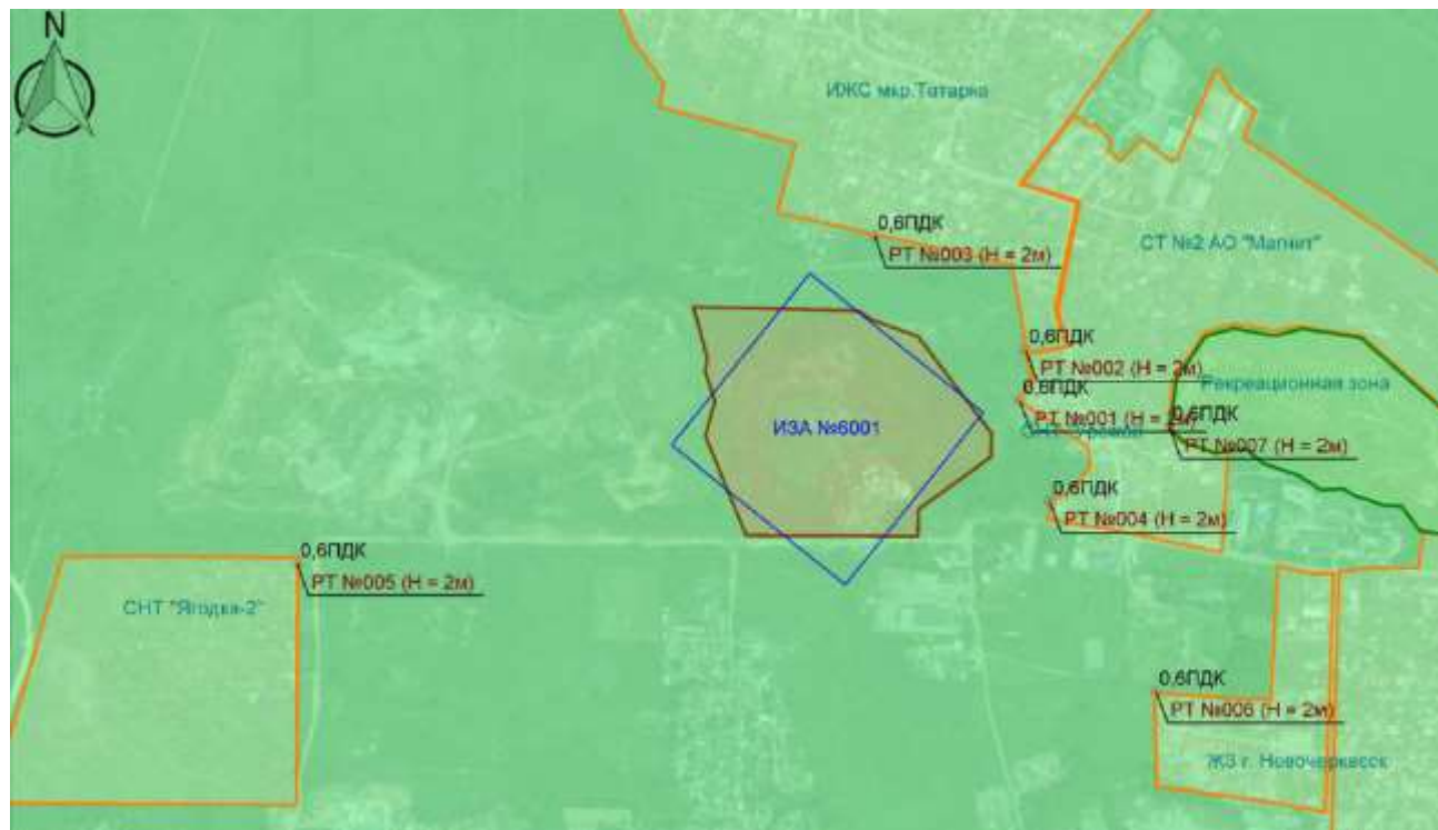
Рисунок 8.3 Карта-схема распределения изолиний максимальных концентраций загрязняющих веществ на существующее положение на полигоне ТКО г. Новочеркасск
