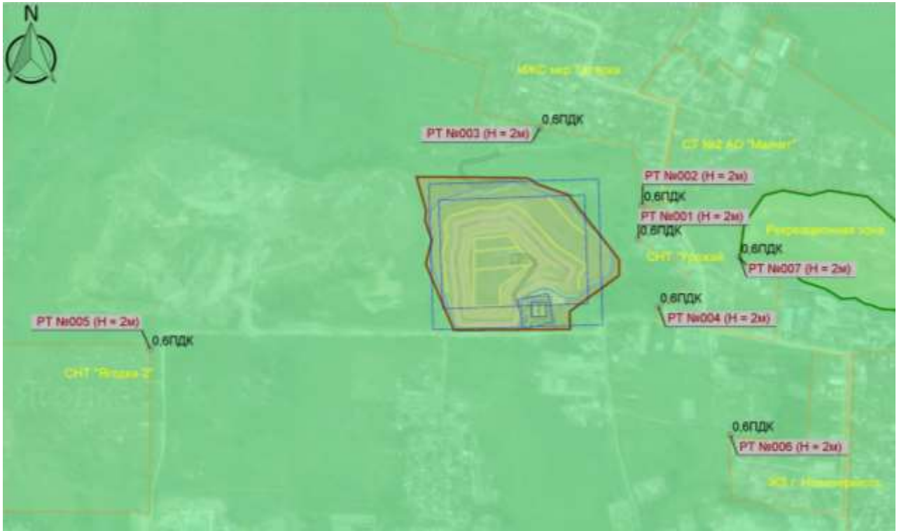
Рисунок 8.8 Карта-схема распределения изолиний максимальных концентраций загрязняющих веществ в пострекультивационный период на полигоне г. Новочеркасск
