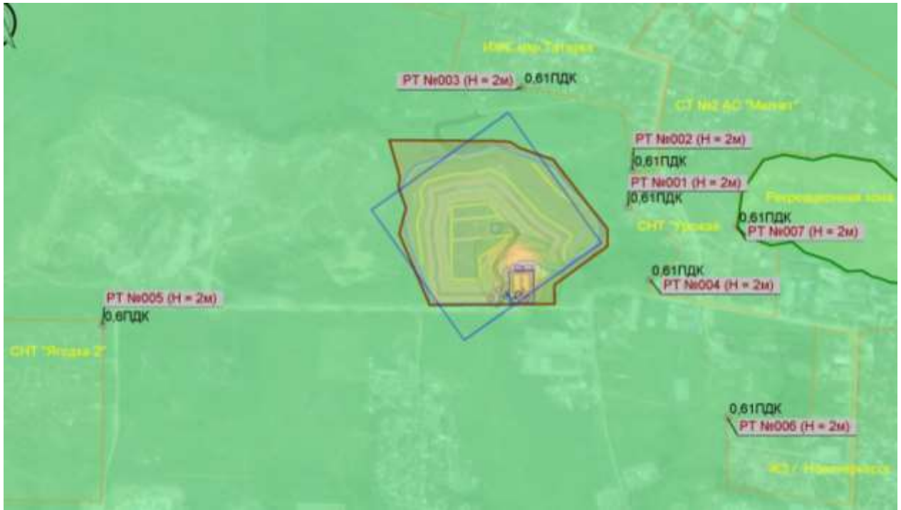
Рисунок 8.5 Карта-схема распределения изолиний максимальных концентраций загрязняющих веществ в строительный период на свалке г. Новочеркасск
