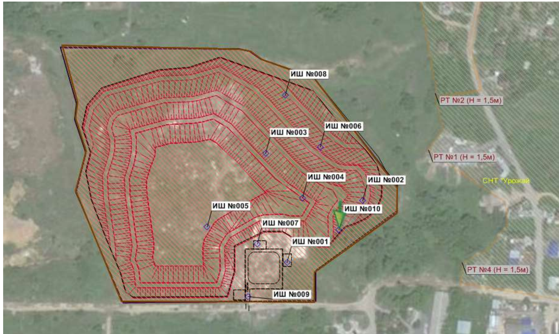
Рисунок 8.10 Карта-схема площадки с источниками шума на территории свалки в период строительства (рекультивация)
