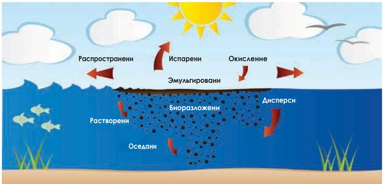
**Рисунок 15.1 – Физико-механические процессы при попадании нефтепродуктов в воду**
