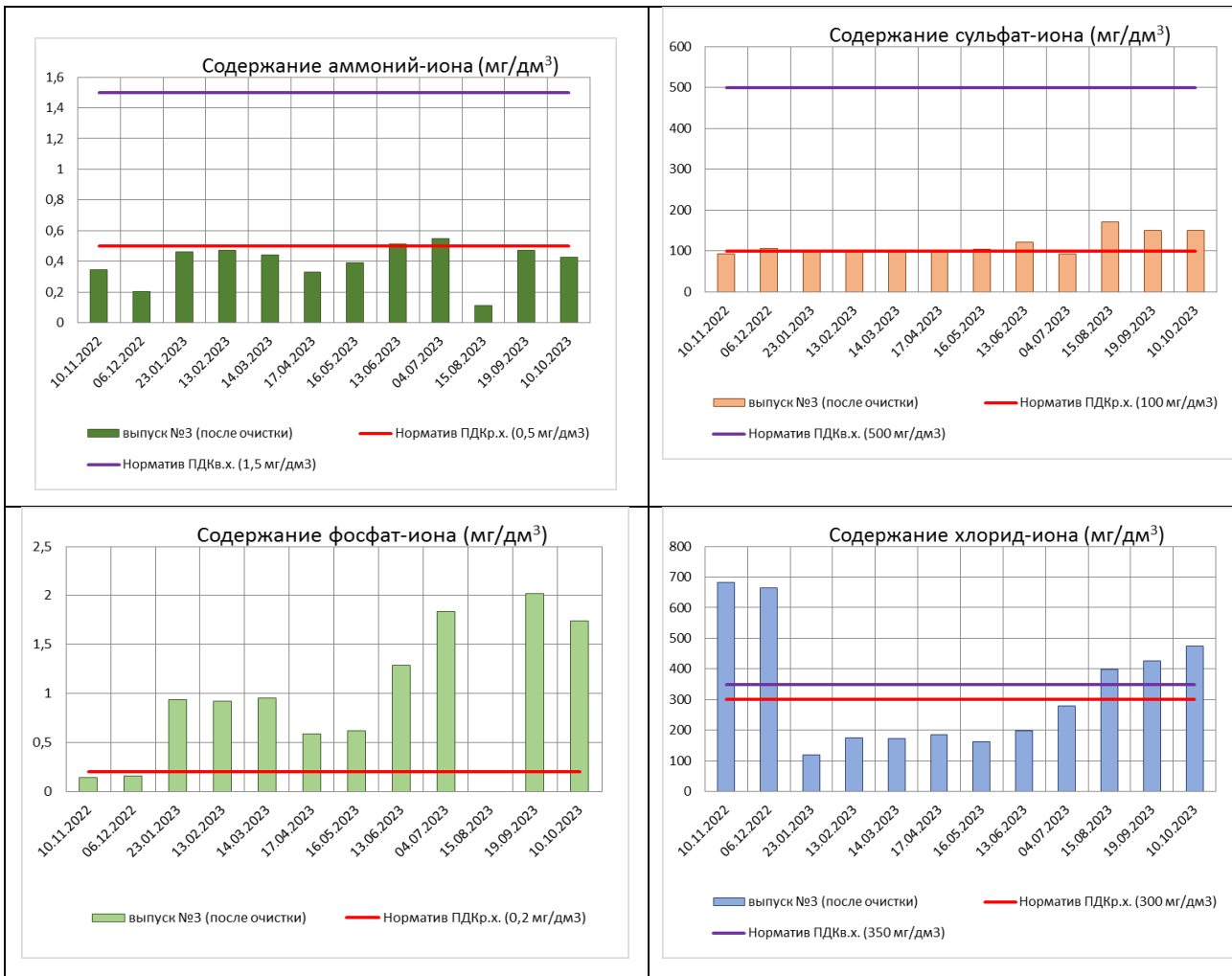
Рисунок 5.44 – Сравнение качества сточных вод: неорганические соединения (кроме металлов и металлоидов) до и после очистки до и после очистки на сооружениях механической очистки. Выпуск №3: р. Преголя
