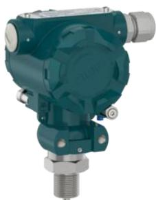
Датчик ПД100 представляет собой преобразователь давления с сенсором типа КНК (кремний на кремнии) с мембраной из нержавеющей стали, с выходным сигналом 4...20 мА. Датчик имеет «полевой» корпус с металлическим кабельным вводом под небронированный кабель 6–12 мм.
