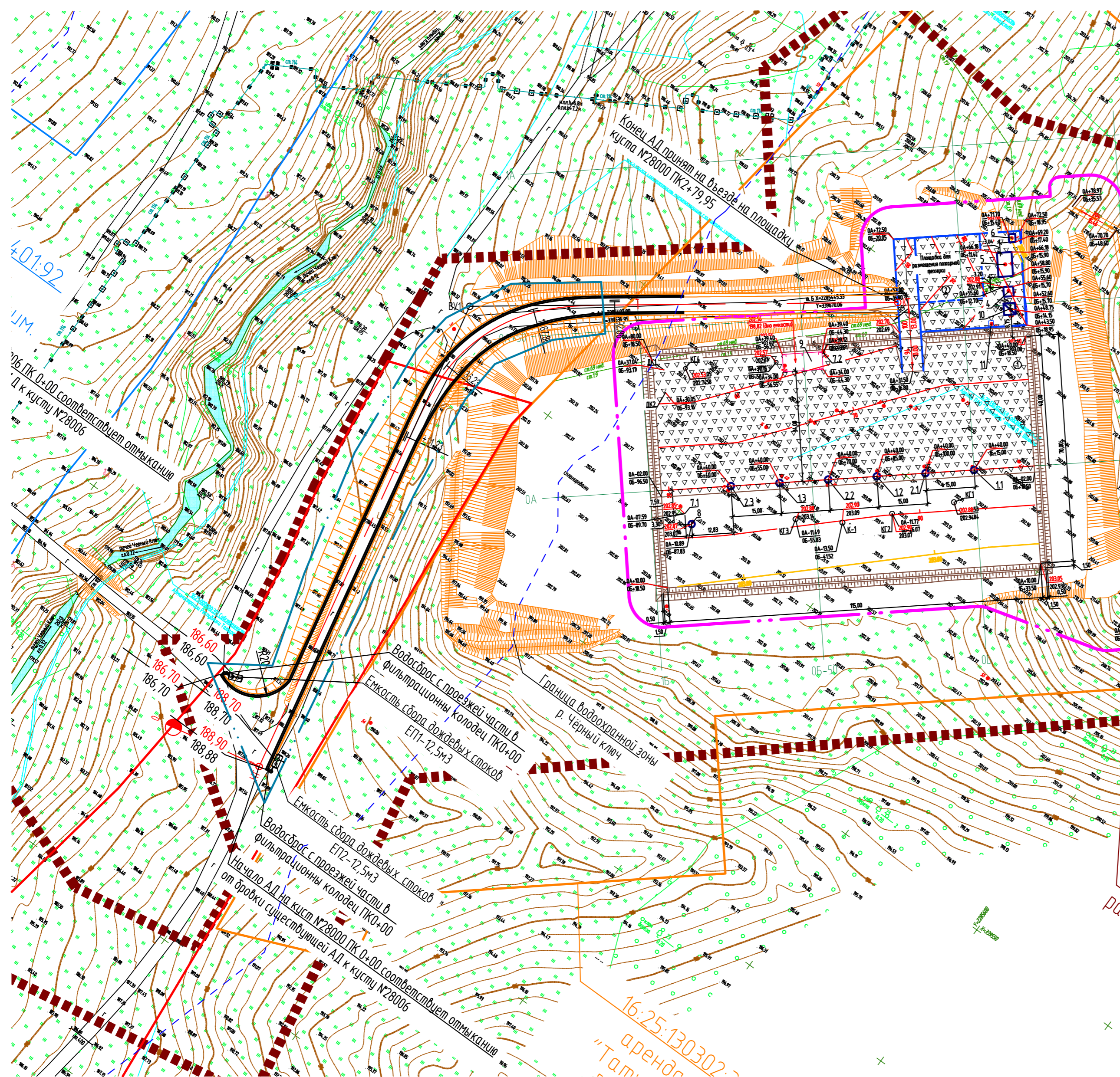
Фрагмент плана автодороги на куст №2800 (1:1000)
