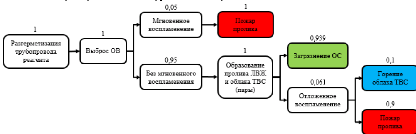
Рисунок 3 - «Дерево событий», иллюстрирующее развитие аварий при разгерметизации оборудования содержащего метанол.
