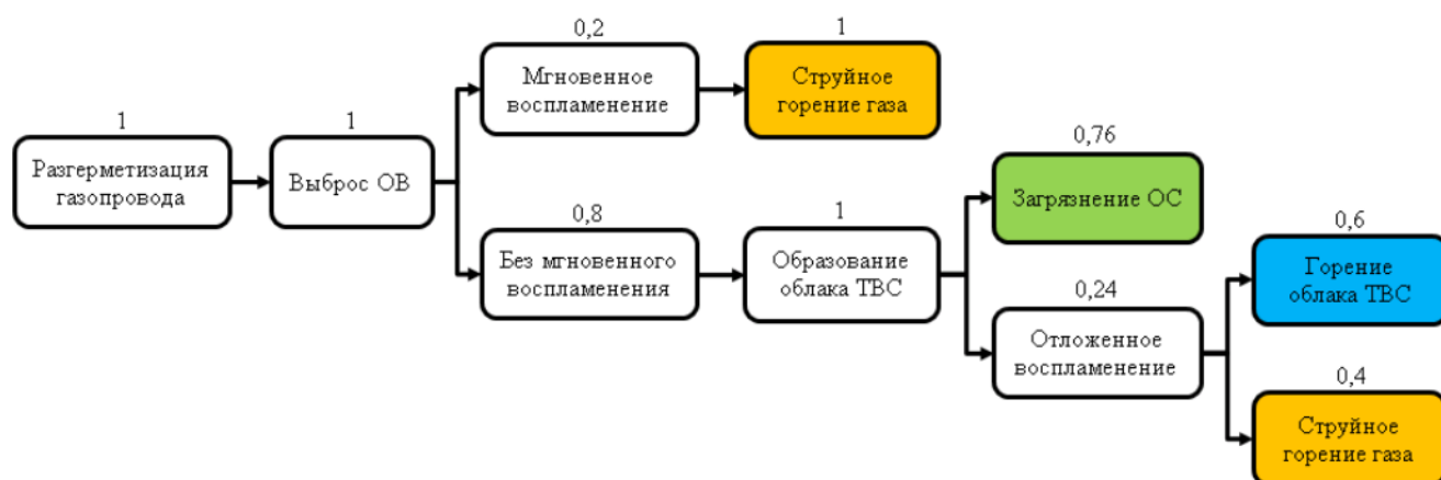
Рисунок 2 - «Дерево событий», иллюстрирующее развитие аварий при разгерметизации оборудования содержащего газ под давлением.
