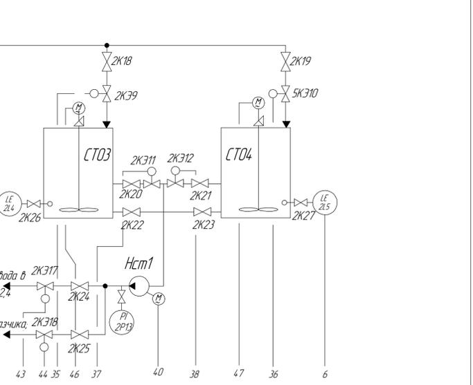
Схема очистки промывных вод
