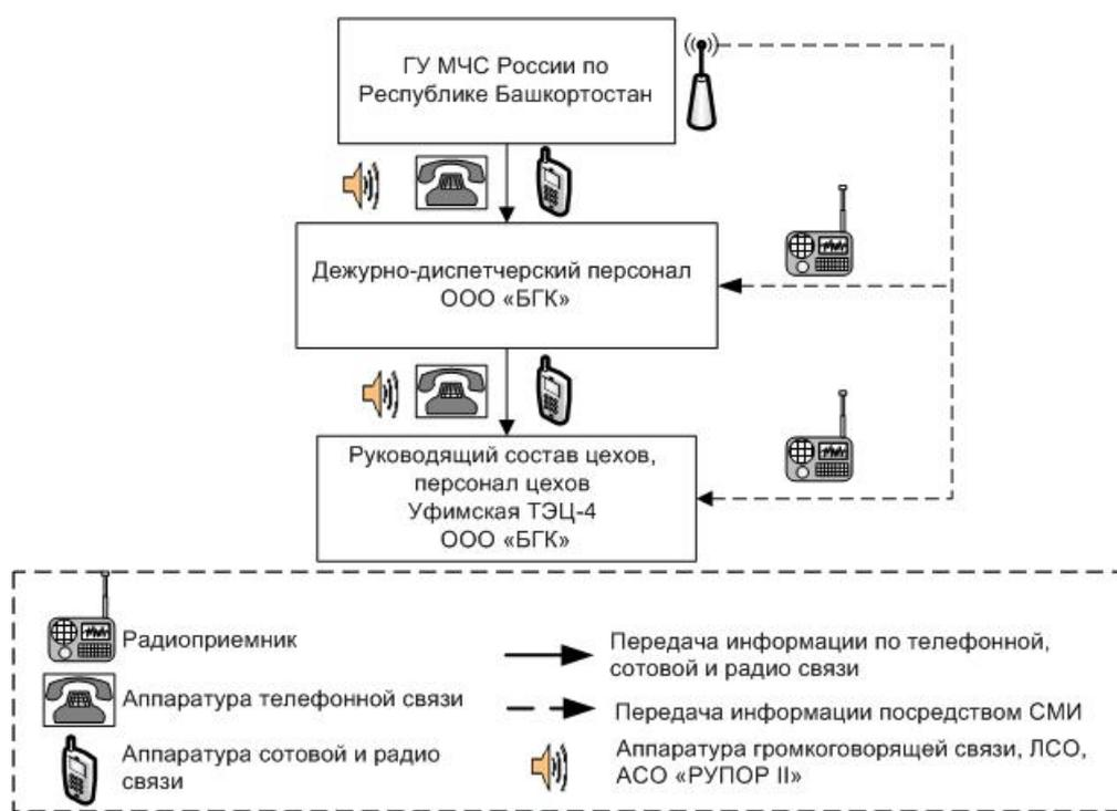
Рисунок 2 - Схема оповещения производственного персонала по сигналам ГО
