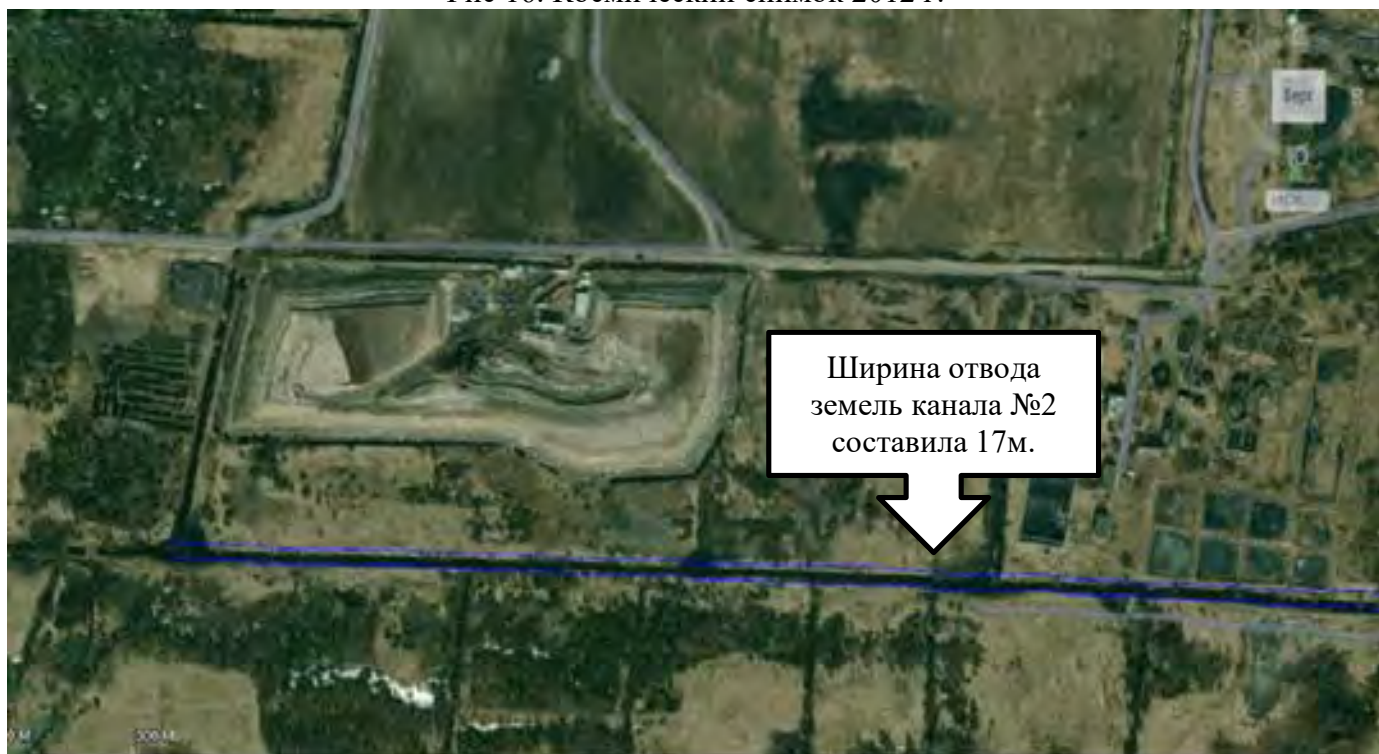
Рис 17. Схема ширины отвода земель канала №2
