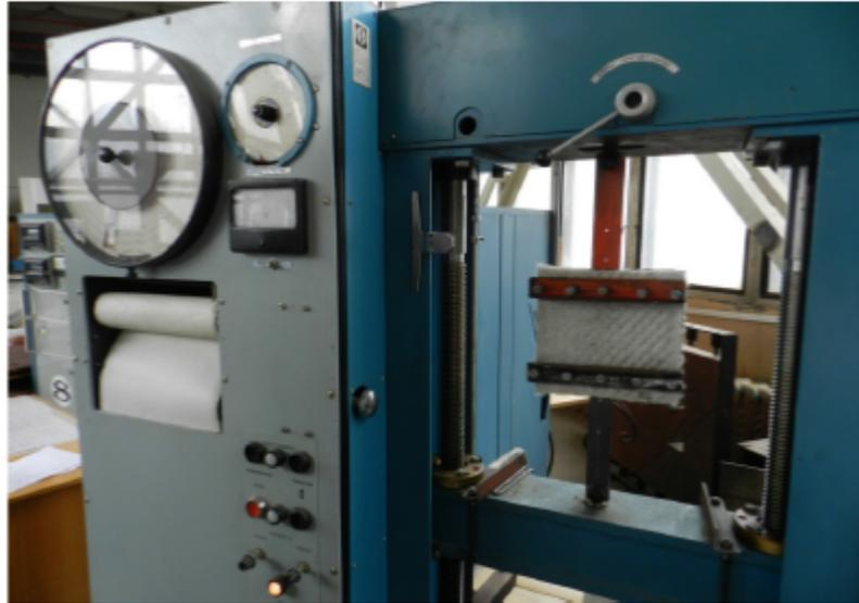
Фото 5 – испытание на разрыв исходного образца бентомата
