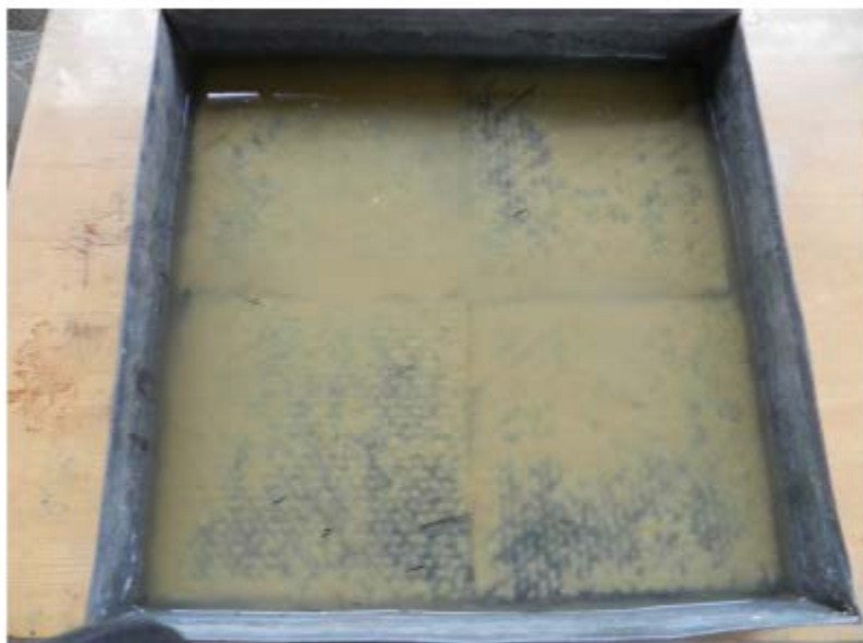
Фото 6 – образцы бентомата в емкости с дистиллированной водой перед загрузкой в камеру тепла и холода
