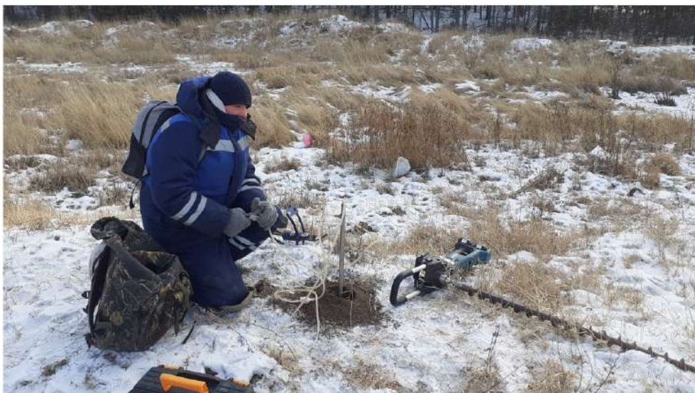
Рис 4-5. Отбор газогеохимической пробы
