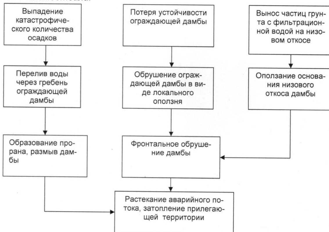
Поражающим фактором при гидродинамической аварии является динамическая сила аварийного стока, определяемая шириной фронта потока и скоростью его продвижения.
