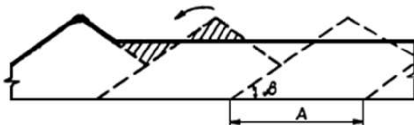
Рисунок 2.1 – Расчетная схема к определению объемов земляных работ при планировке гребневидных отвалов и создании поверхности
