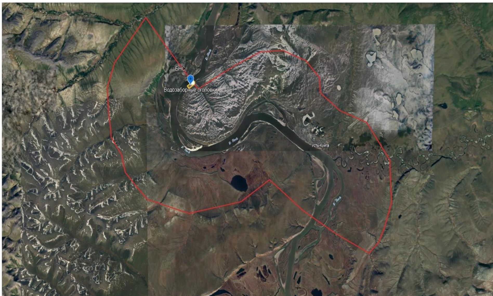
Рисунок 7 - Ситуационный план с проектируемыми границами третьего пояса зоны санитарной охраны поверхностного источника водоснабжения р. Яна
