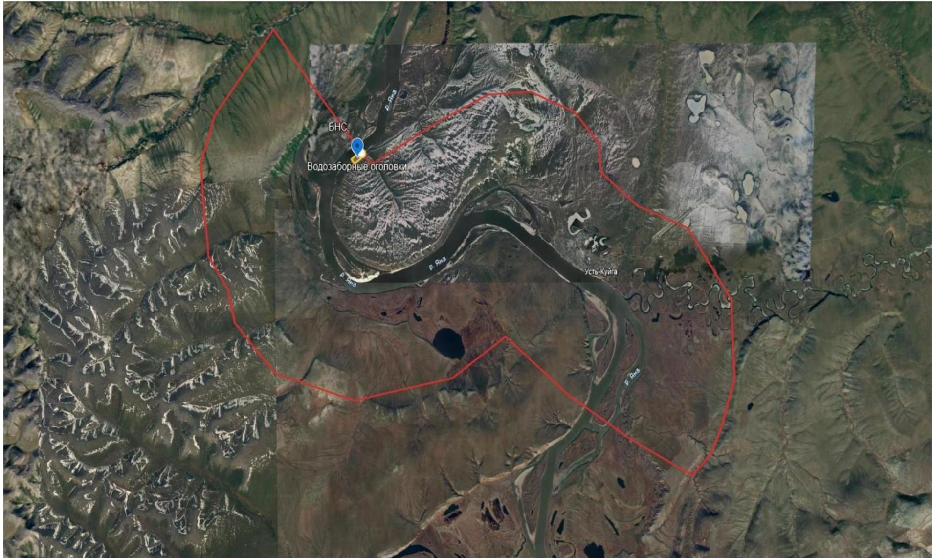
Рисунок 12 - Ситуационный план с проектируемыми границами третьего пояса зоны санитарной охраны поверхностного источника водоснабжения р. Яна
