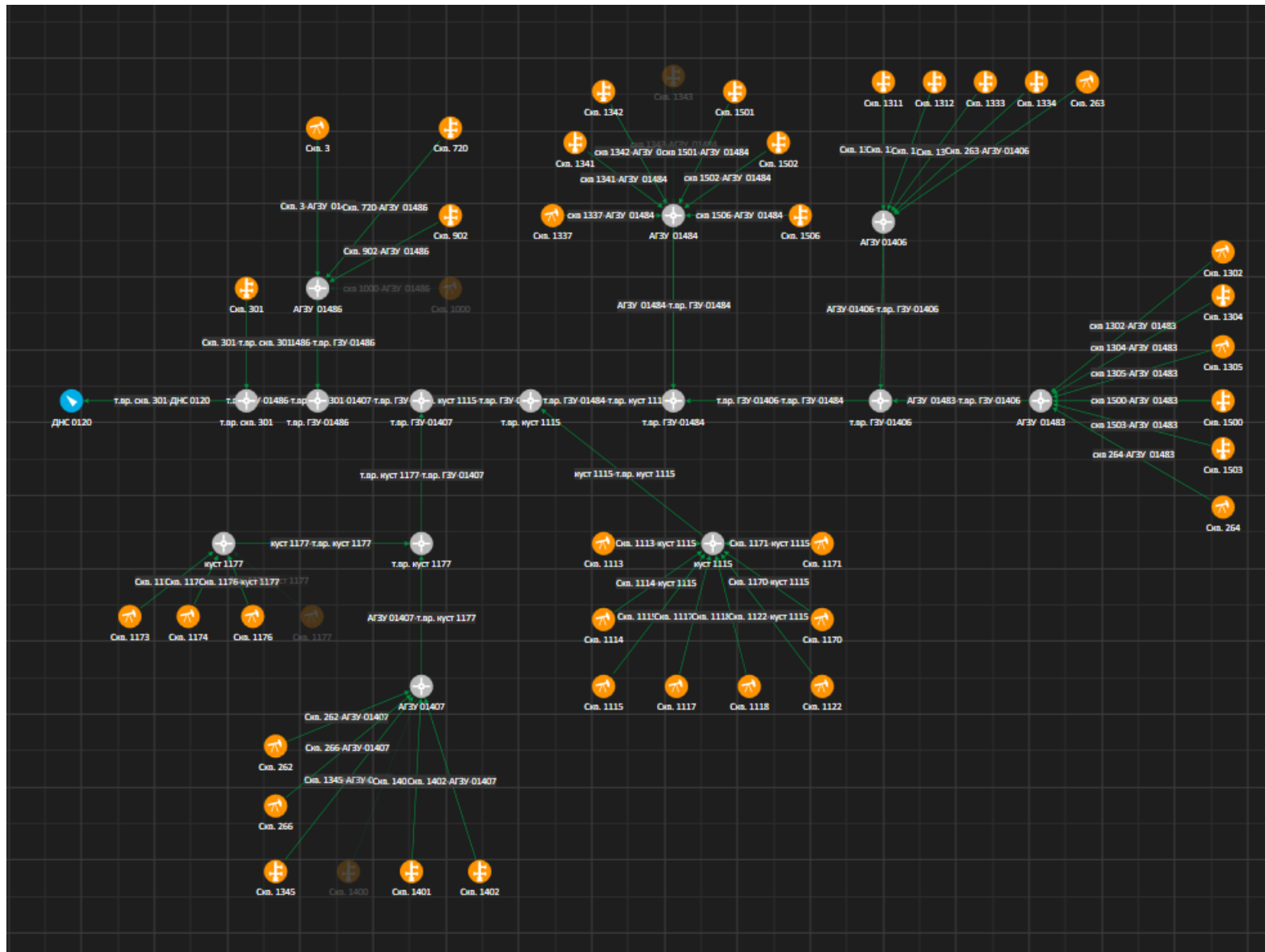
Рисунок 1.2.1 - Расчетная гидравлическая схема текущего состояния системы сбора Дороховского месторождения
