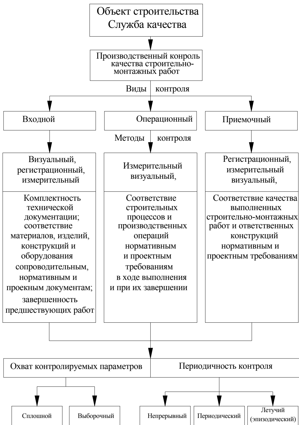
Рисунок 1 - Схема производственного контроля качества строительно-монтажных работ
