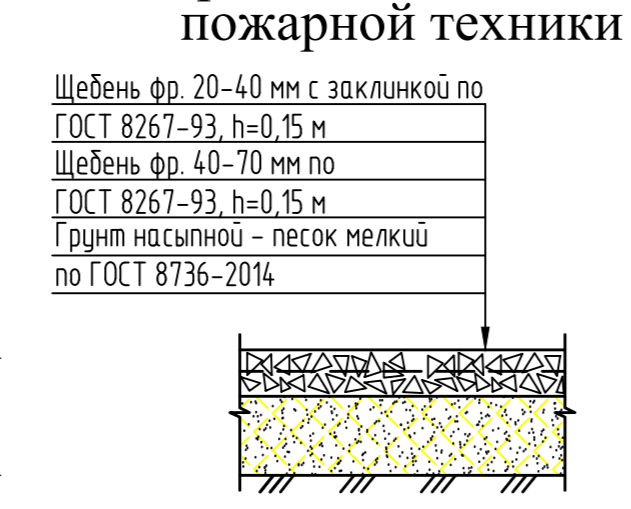
Конструкция щебеночного покрытия площадки для пожарной техники
