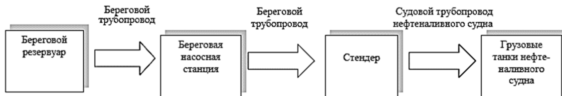
Рисунок 2.1.1.1 – Технологическая схема загрузки топлива на суда ООО «Наяда»
