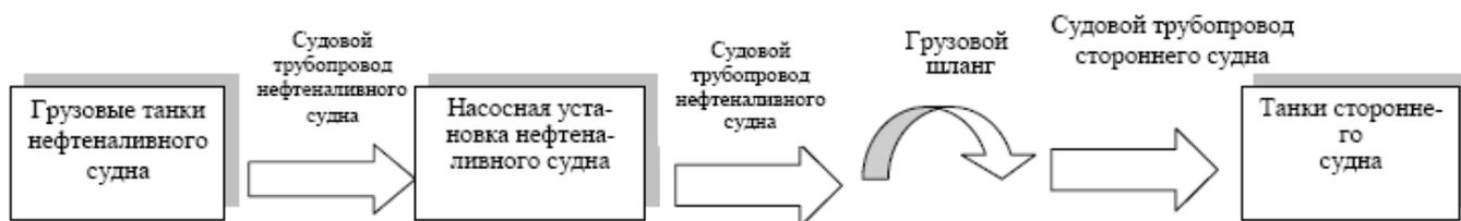
Рисунок 2.1.2.1 – Технологическая схема отгрузки топлива на сторонние суда
