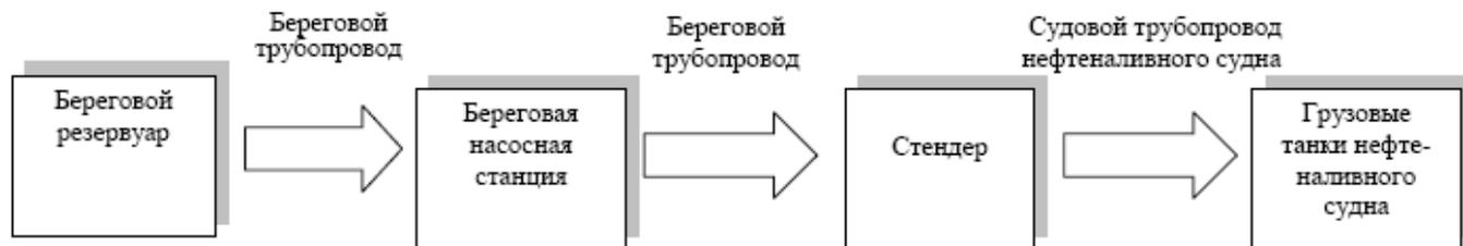
Рисунок 2.1.1.1 – Технологическая схема загрузки топлива на суда ООО «Наяда»
