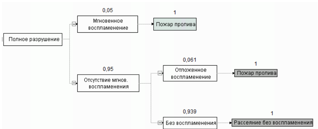
Рисунок 12.1 – «Дерево событий» для аварий с разливом дизельного топлива
