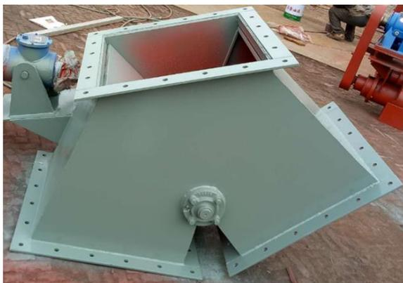
Верхняя часть соединена с шиберной задвижкой для сброса обезвоженного осадка, а нижняя часть соединена со шнековым транспортером (не входит в поставку).
