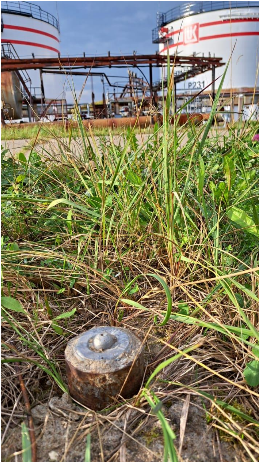
Рисунок Д1 Грунтовый репер РпЗ
