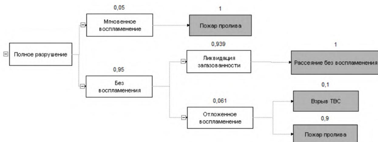
**Рисунок 30 – Дерево событий для сценариев при  $t_{всп} \geq 61^\circ\text{C}$**
