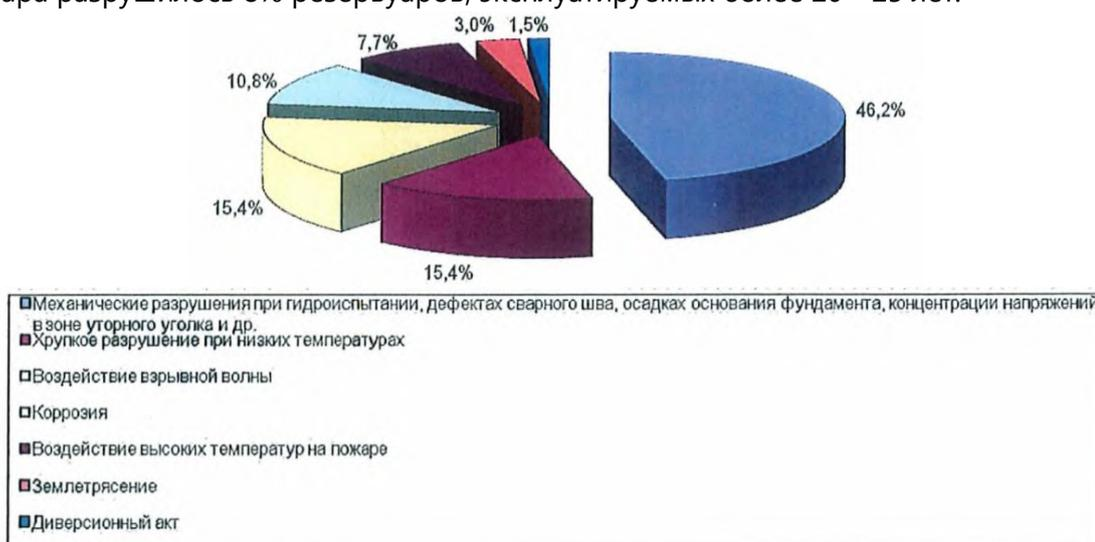
**Рисунок 10 – Причины разрушения резервуаров**
