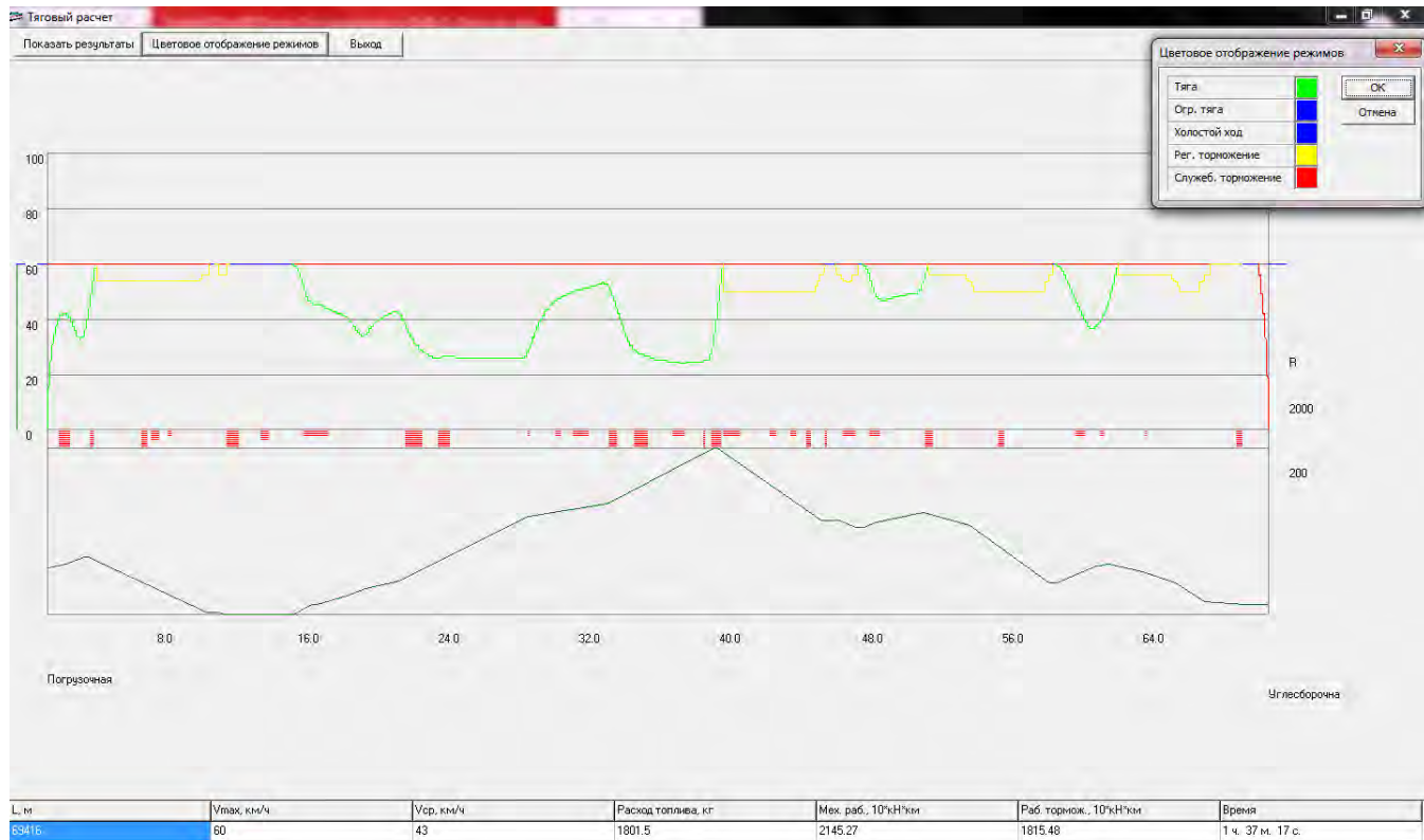
Рисунок 2.7 – Графическое изображение движения груженого поезда на участке ст. Углепогрузочная – ст. Харанхой
