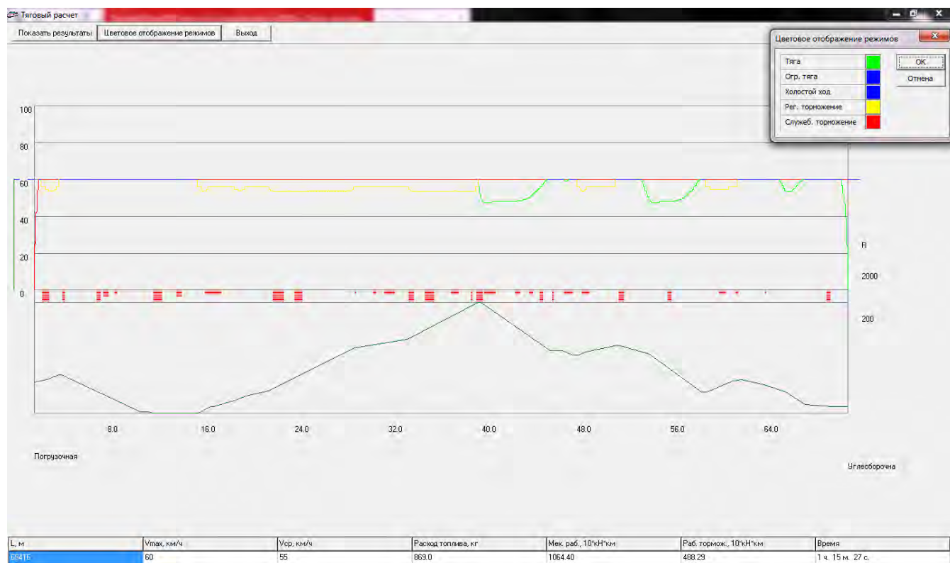
Рисунок 2.8 – Графическое изображение движения порожнего поезда на участке ст. Харанхой – ст. Углепогрузочная
