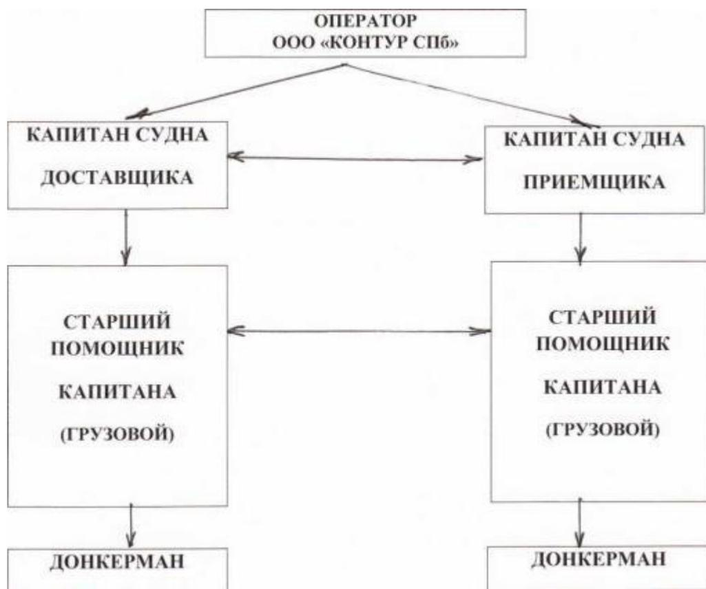
Рисунок 4.2 Схема управления погрузочно-разгрузочными работами
