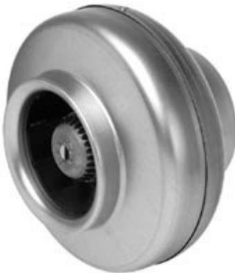
Настенные вентиляторы KVFU оснащены асинхронным двигателем с внешним ротором и рабочим колесом с загнутыми назад лопатками. Корпус вентиляторов изготавливается из оцинкованной стали.
