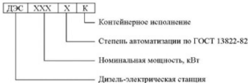
Пример записи изделия при заказе ДЭС мощностью 100 кВт, автоматизированной по 3-й степени, при заказе и в других документах: «Электростанция ДЭС-100.3 К, ТУ 3378-005-54308384-2004». Заказ осуществляется на основе опросного листа, заполняемого заказчиком. (Форма опросного листа приведена на стр. 10)
