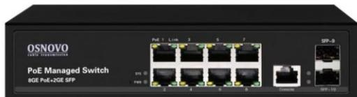
Коммутатор L2 управляемый 10 портовый; 8xRJ-45 POE 10/100/1000 Base-T, Метод А (IEEE 802.3af/at) до 30Вт, бюджет POE 150Вт; Uplink 2xSFP 10/100/1000 Base-T; AC 100-240В ; встроенная грозозащита 3кВ; 210x35x150мм; -10...+50°С. Поддержка режима CCTV передачи данных и питания до 250м.
