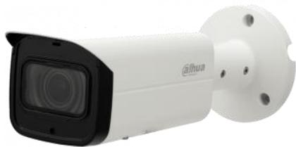
Профессиональная телекамера IP 4 Мп уличная цилиндрическая; 1/3" CMOS матрица; 2688×1520-20к/с; моторизированный объектив: 2.7-13,5 мм; чувствительность: 0.03 Лк/0 Лк; ИК-подсветка 80м; H.265+/H.265/H.264+/H.264; режим "день/ночь"; Видеоаналитика; WDR, BLC,HLC; 3D DNR; Micro SD до 128 Gb; DC12В/ePOE; 11,5 Вт; IP67; -30...+60°; 244x79x80 мм.
