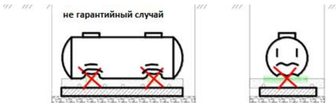
Монтаж изделия на железобетонную плиту выполняется после того, как бетон наберет прочность. При установке горизонтальных изделий на железобетонной основе, выполнить подсыпку из слоя песка толщиной не менее 150-200мм с последующим утрамбовки (см. Рис.5).
