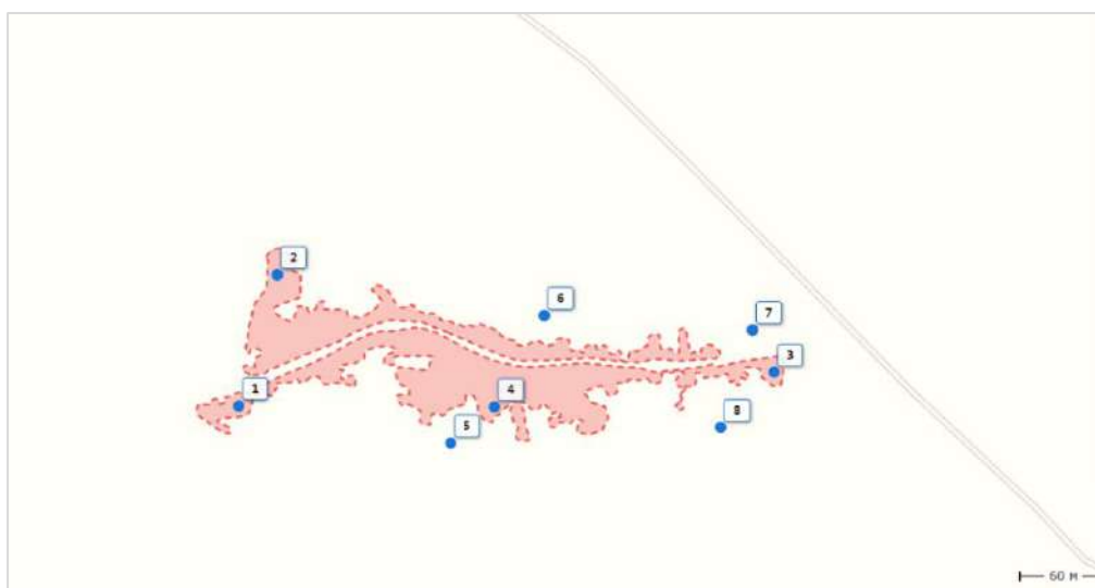
Рисунок 2.3 – Схема отбора проб грунта на объекте
