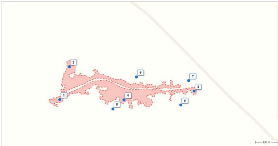
Рисунок 2.9 – Схема отбора проб грунта на объекте
