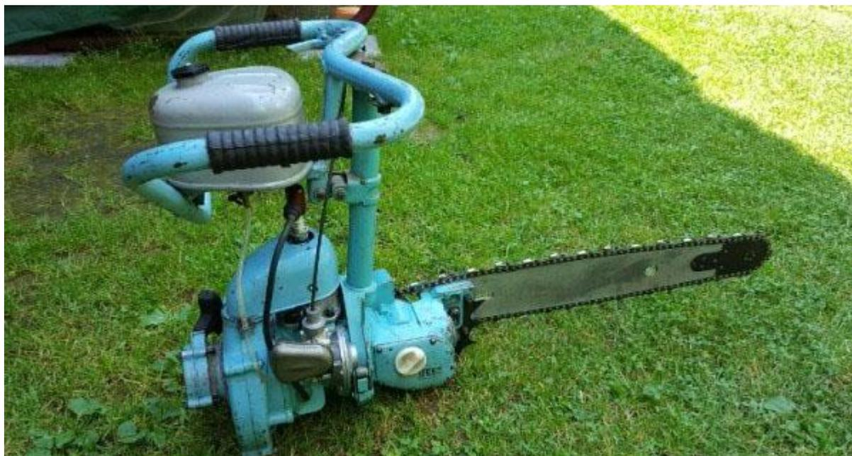
Для снижения уровня шума пила оборудована глушителем, а **уровень издаваемого шума 106 дБ**. В бензопилу Дружба 4М-Электрон установлен карбюратор КМП-100У или КМП-100-АР. Присутствуют системы автоматического торможения и смазки пильной цепи. Вес 12,5 кг.
