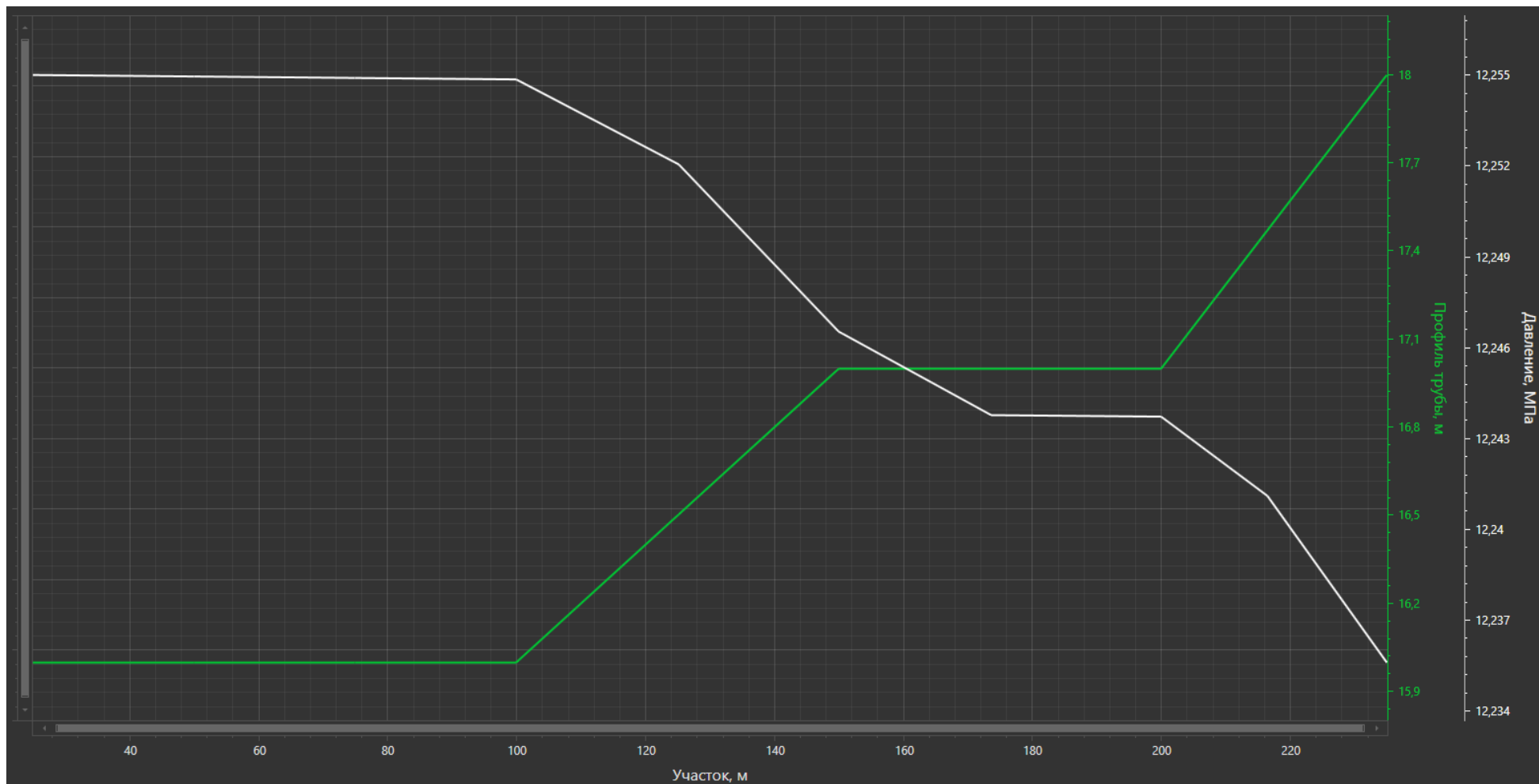
Рисунок 2.3.11 – Распределение давления по водоводу «БГ к.1 – Скв. №68»
