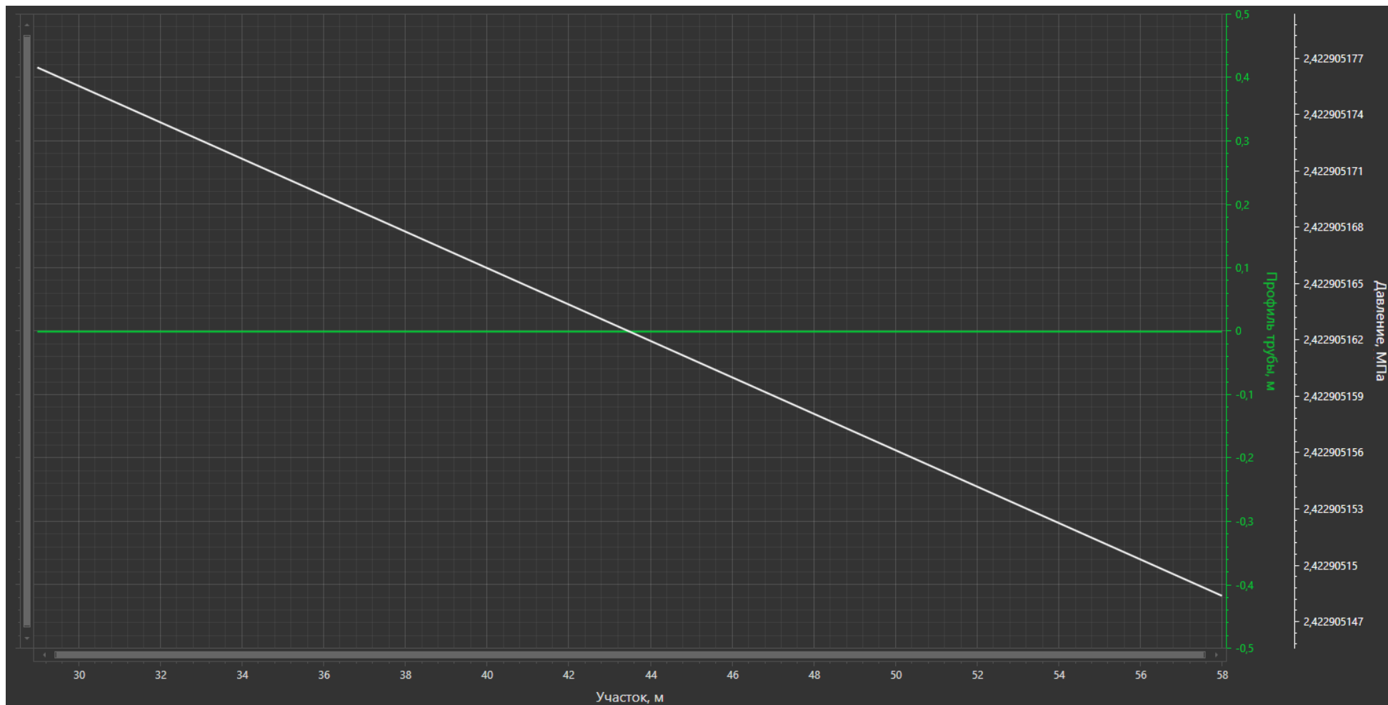
Рисунок 1.3.15 – Распределение давления по нефтепроводу «Скв. №63 - т.вр. «скв.1 - т.вр. ГЗУ-0231 - ГЗУ-0229»
