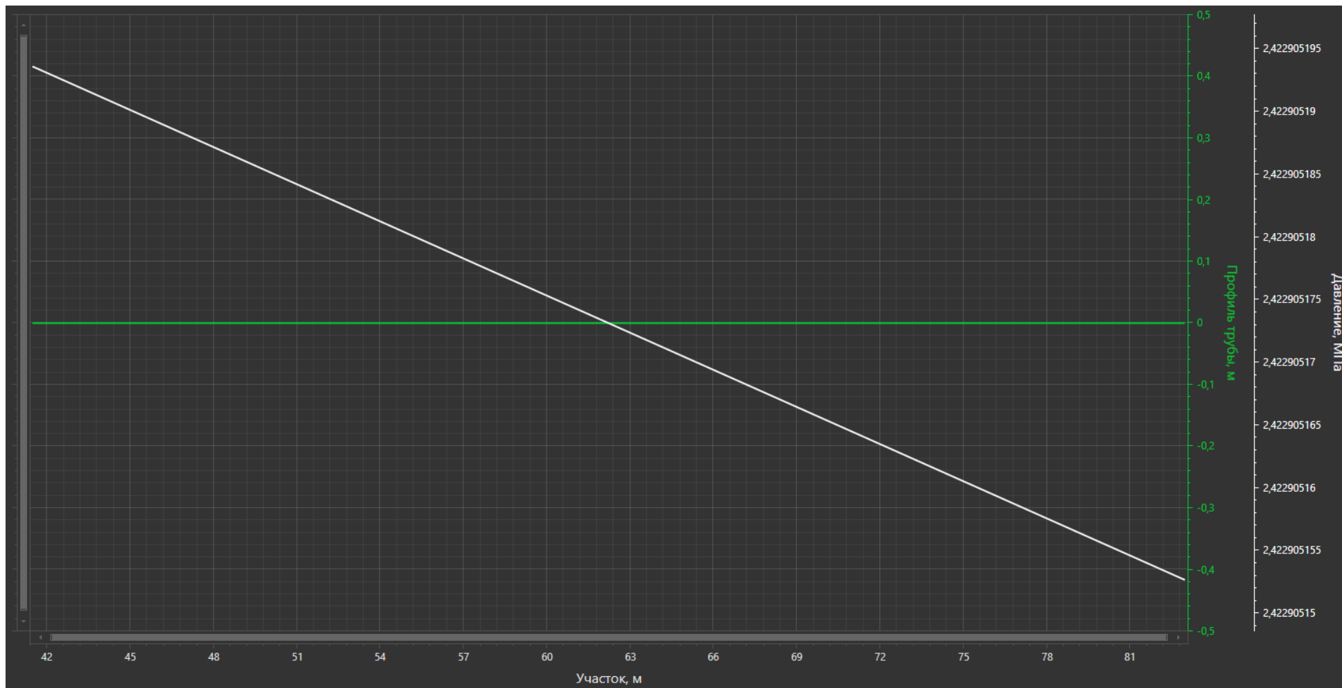
Рисунок 1.3.7 – Распределение давления по нефтепроводу «Скв. №66 - т.вр. «скв.1 - т.вр. ГЗУ-0231 - ГЗУ-0229»
