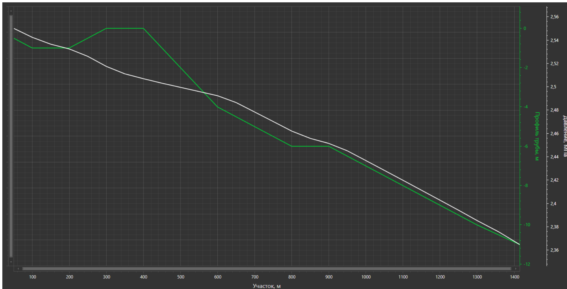
Рисунок 1.3.40 – Распределение давления по нефтепроводу «греб. К.4 – т.вр. «скв.3 - т.вр. скв.1 - т.вр.ГЗУ-0231 - ГЗУ-0229»
