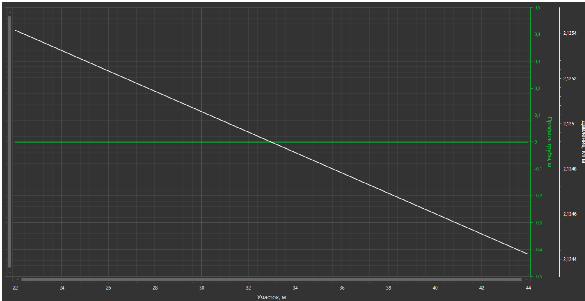
Рисунок 1.3.19 – Распределение давления по нефтепроводу «Скв. №49 - греб. К.2»
