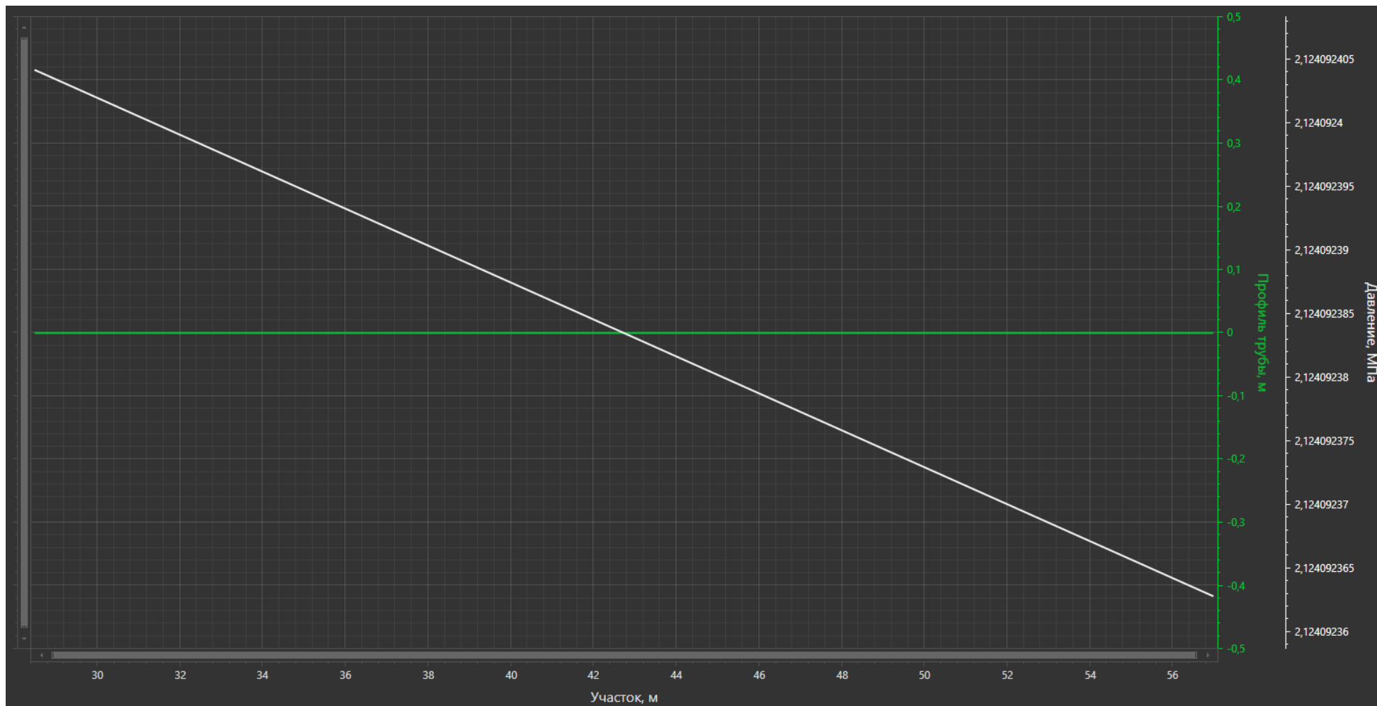
Рисунок 1.3.20 – Распределение давления по нефтепроводу «Скв. №75 - греб. К.2»
