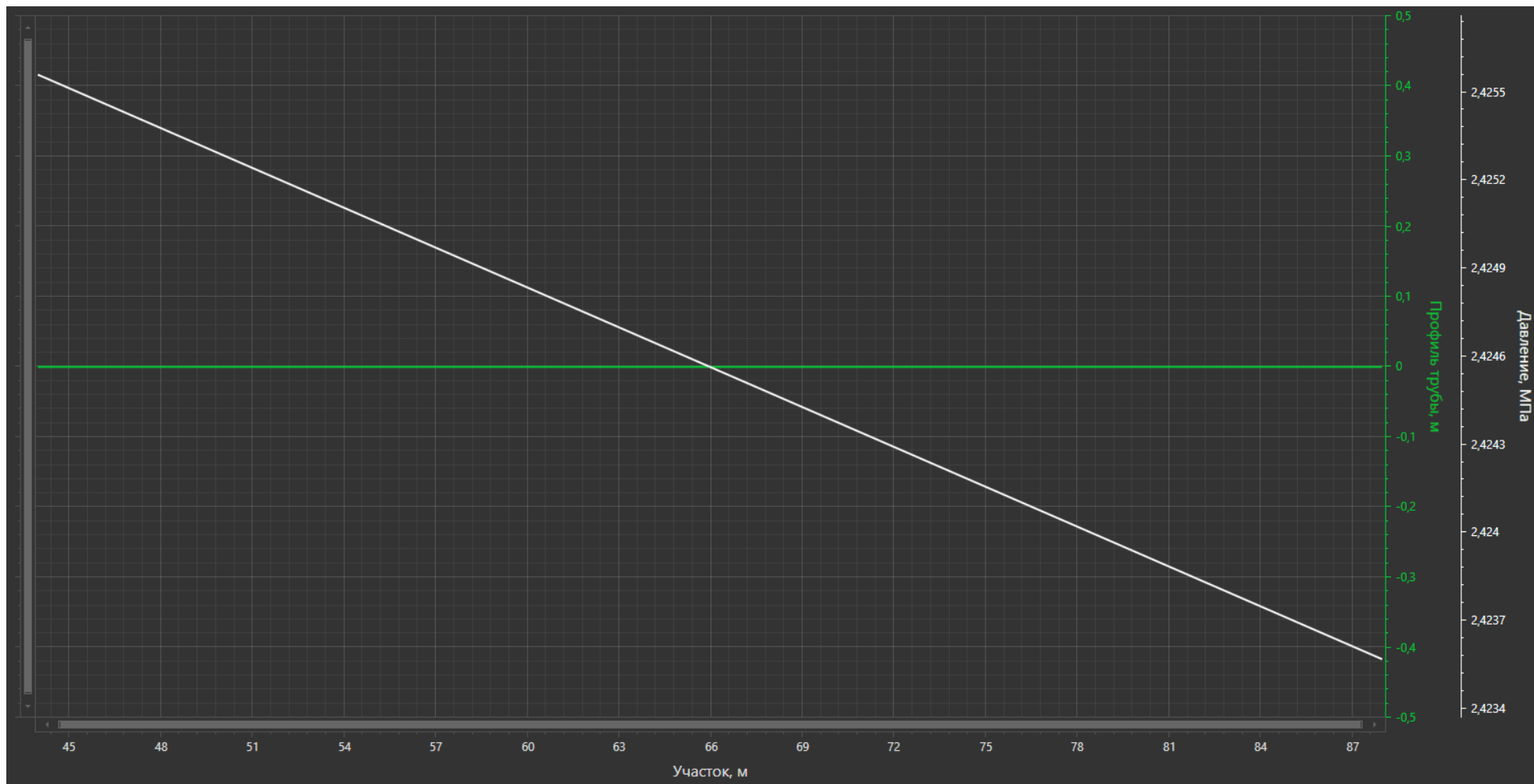
Рисунок 1.3.8 – Распределение давления по нефтепроводу «Скв. №46 - т.вр. «скв.1 - т.вр. ГЗУ-0231 - ГЗУ-0229»
