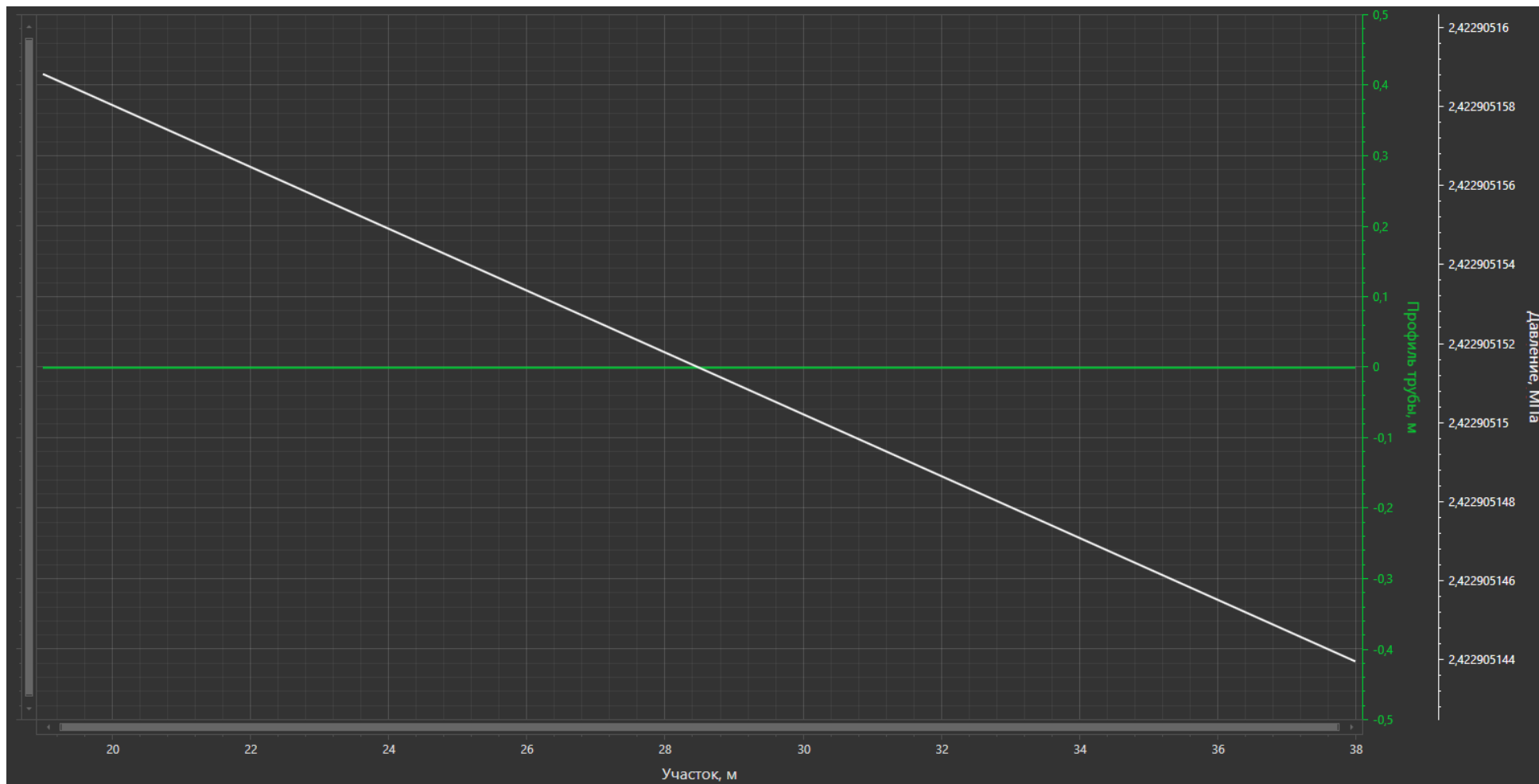
Рисунок 1.3.3 – Распределение давления по нефтепроводу «Скв. №69 - т.вр. «скв.1 - т.вр. ГЗУ-0231 - ГЗУ-0229»
