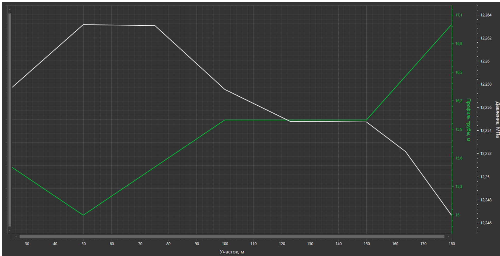
Рисунок 2.3.9 – Распределение давления по водоводу «БГ к.1 – Скв. №67»
