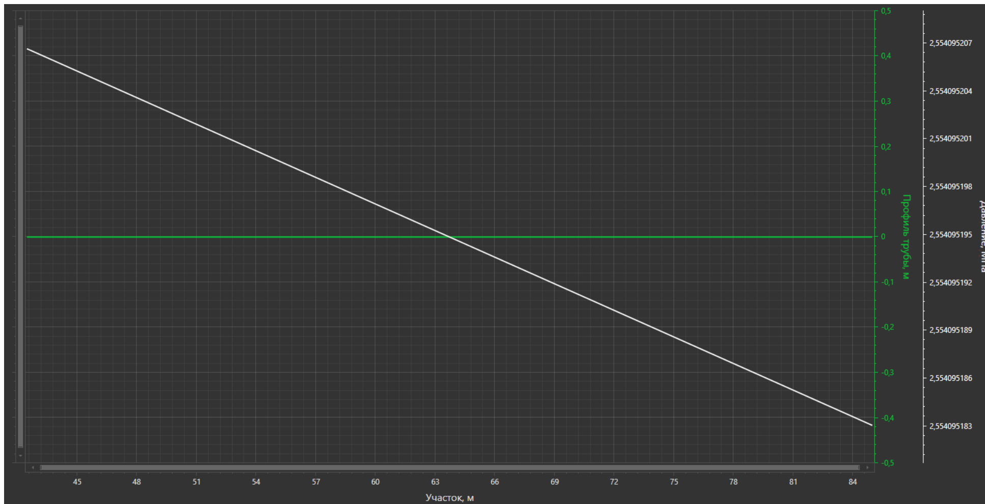
Рисунок 1.3.45 – Распределение давления по нефтепроводу «Скв. №77 - греб. К.4»
