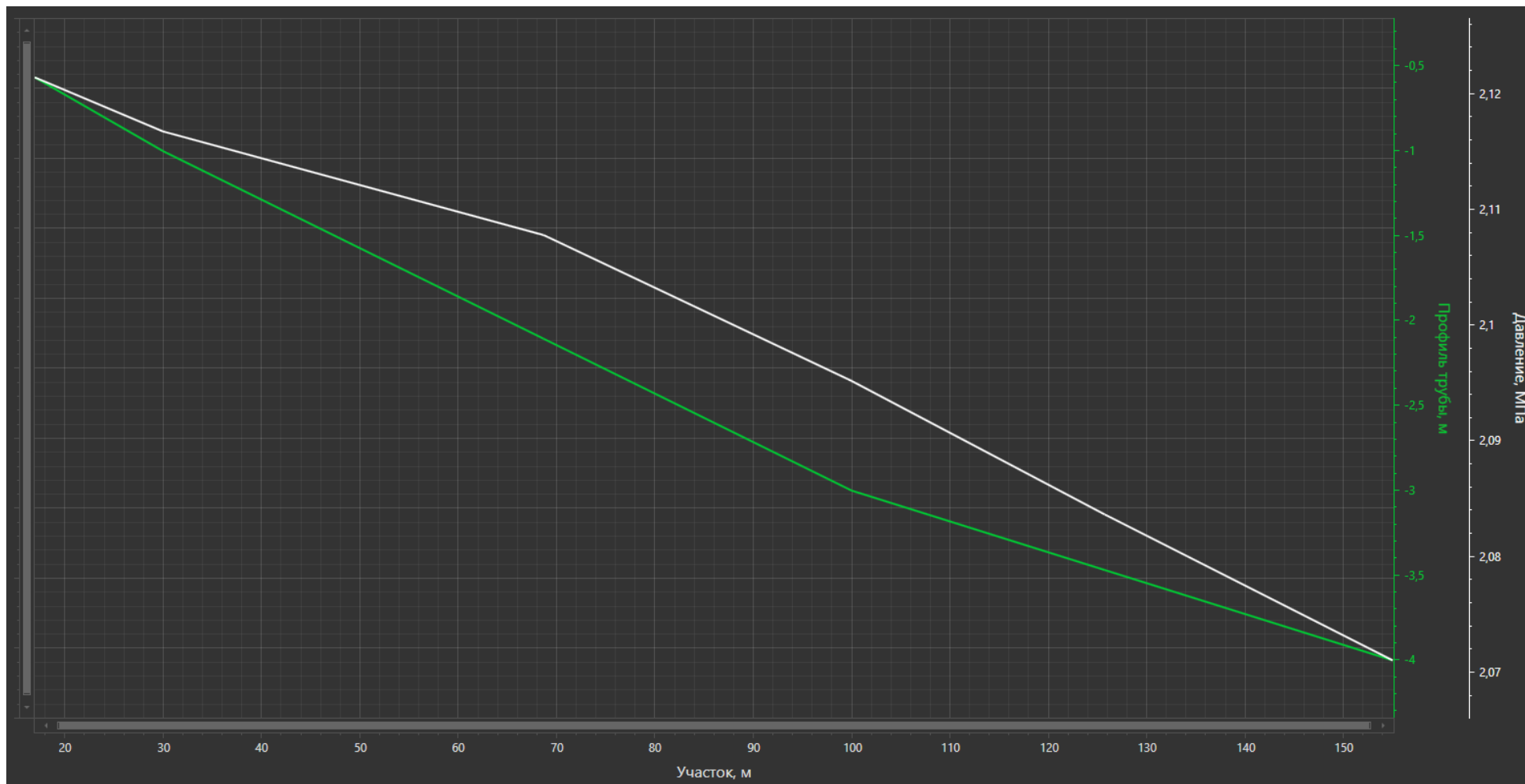
Рисунок 1.3.16 – Распределение давления по нефтепроводу «греб. К.2 – т.вр. «скв.2 - т.вр. скв.3 - т.вр.ГЗУ-0231 - ГЗУ-0229» (ПК 00+00 – ПК 01+55)
