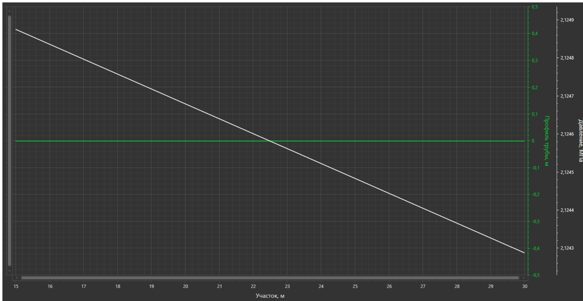
Рисунок 1.3.18 – Распределение давления по нефтепроводу «Скв. №24 - греб. К.2»
