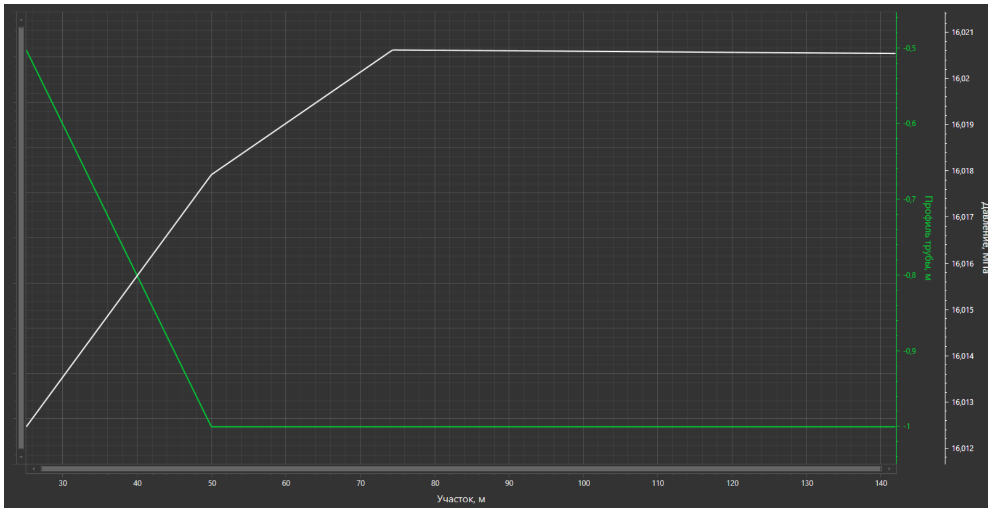
Рисунок 2.4.5 – Распределение давления по водоводу «ВРП на к.3– скв. №8»
