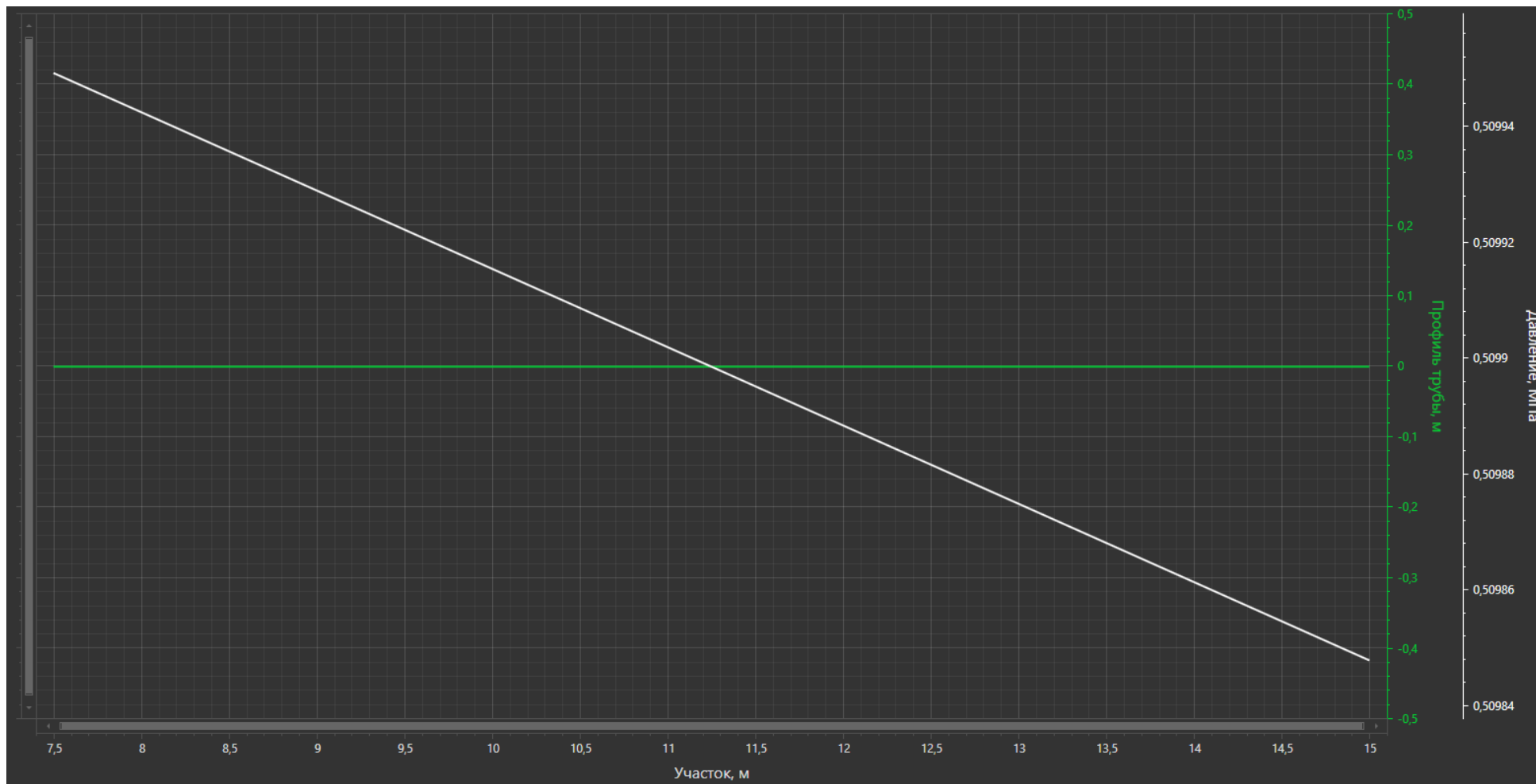
Рисунок 2.4.3 – Распределение давления по водоводу «В/з скв. на к.3 – Шурф к.3»
