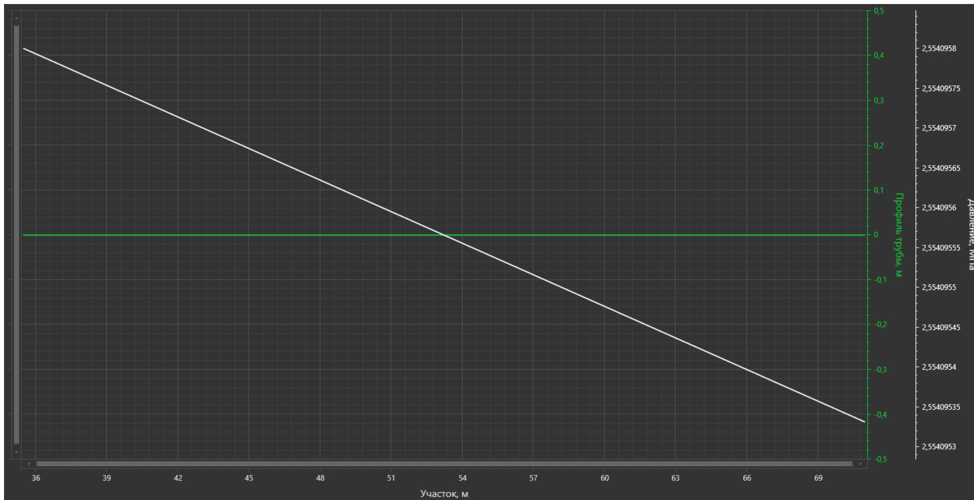
Рисунок 1.3.44 – Распределение давления по нефтепроводу «Скв. №26 - греб. К.4»
