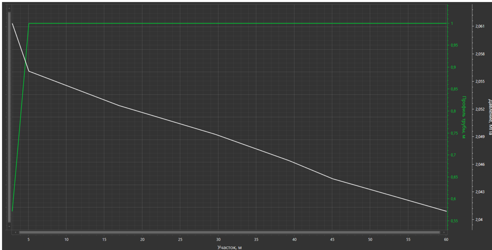
Рисунок 1.3.17 – Распределение давления по нефтепроводу «греб. К.2 – т.вр. «скв.2 - т.вр. скв.3 - т.вр.ГЗУ-0231 - ГЗУ-0229» (ПК 01+55 – ПК 02+15)
