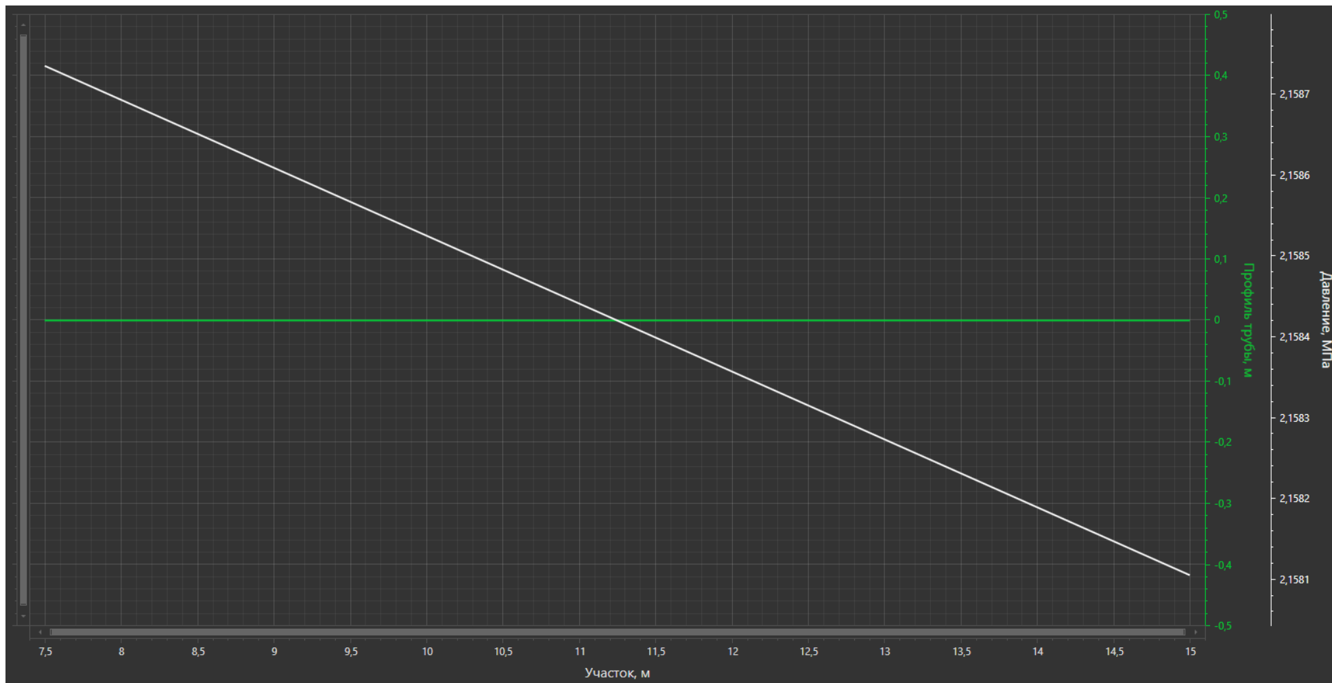
Рисунок 1.3.47 – Распределение давления по нефтепроводу «Скв. №5 - греб. К.5»
