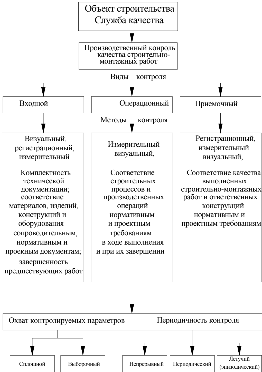
Рисунок 1 - Схема производственного контроля качества строительно-монтажных работ
