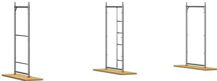
2 этап. Установка рам первого яруса и соединение их горизонтальными и диагональными связями. По краям необходимой длины лесов монтируются рамы ограждения
