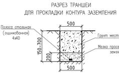
Траншеи для горизонтальных заземлителей должны быть заполнены сначала органическим грунтом, не содержащим щебня и строительного мусора, с уплотнением на глубину 200 мм, а затем местным грунтом.
