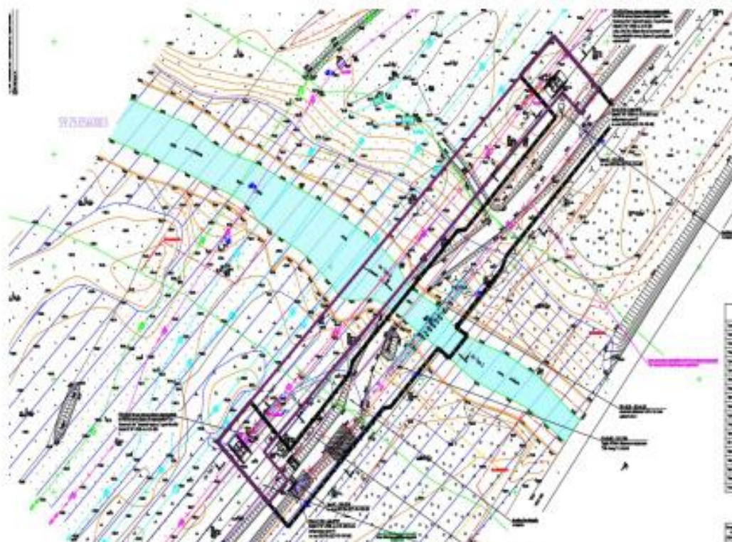
Рисунок 1 – Схема участков работ по прокладке/ демонтажу трубопровода и расположения временных и постоянных объектов строительства на пересечении с р. Глухая Вильва
