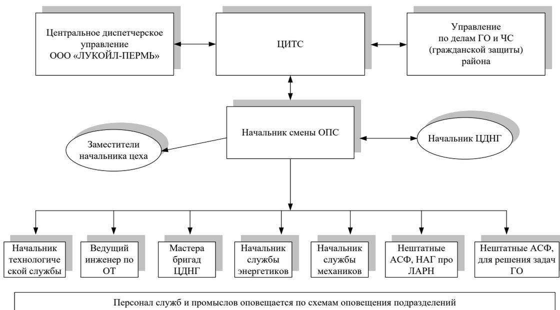
Рисунок 2 – Схема оповещения ЦДНГ (ЦТГ) по сигналам ГО
