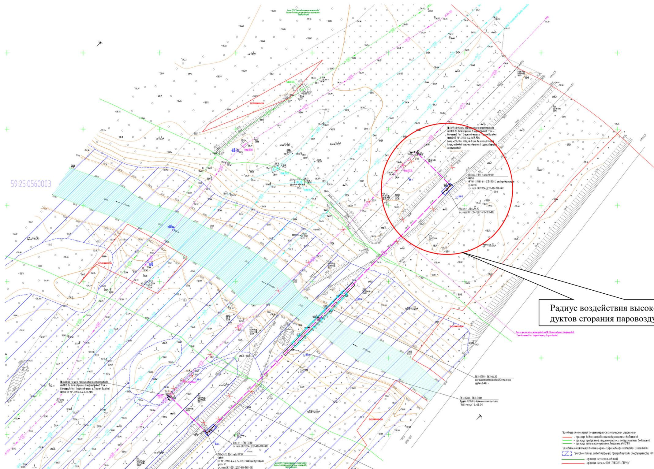
Радиус воздействия высокотемпературных продуктов сгорания паровоздушного облака 43м.
