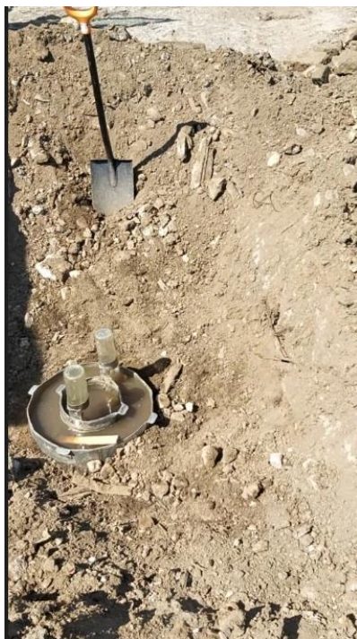
Рисунок 3.3.7 – Выполнение налива в шурф в грунтах ТГ-5 в восточной части участка работ
