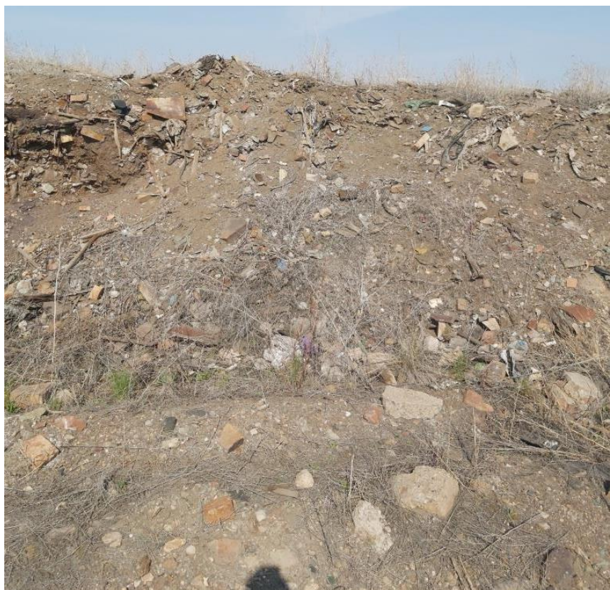
Рисунок 3.3.9 – Толща насыпных грунтов на участке работ
