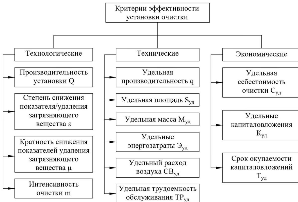
**Рисунок 3.1. Схема классификации критериев эффективности блочно-модульных установок очистки фильтров ТКО**
