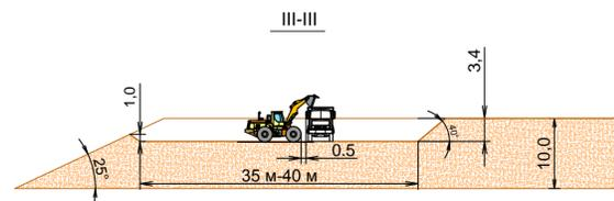
Нанесение рекультивационного слоя на поверхность отвала
